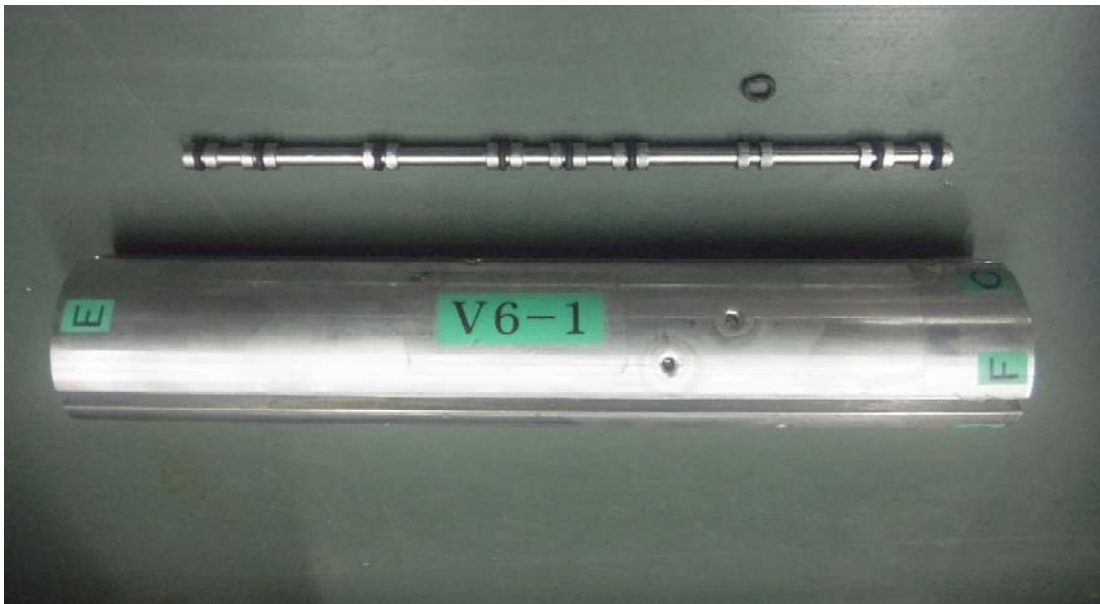
図 6.4.7-3 破損した3番0リングの状態
