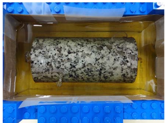
② 脱型直前（流し込みから 1 日経過）
