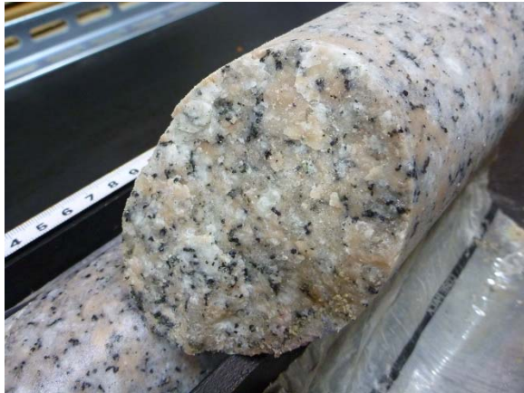
図 5.3.1-9 介在鉱物が認められない例 (15MI52 号孔 13.85 mabh 割れ目)
