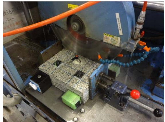
② 供試体の切断（スリットの挿入）
