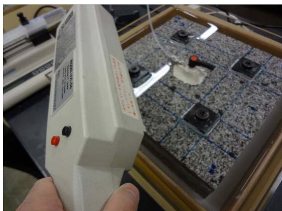
③ 紫外線ランプによるレジンの流出の確認
