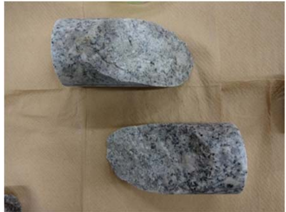
② 割れ目面
