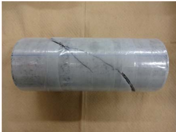
③ 養生テープによる固定 (流入出箇所はスリットを入れ開放)
