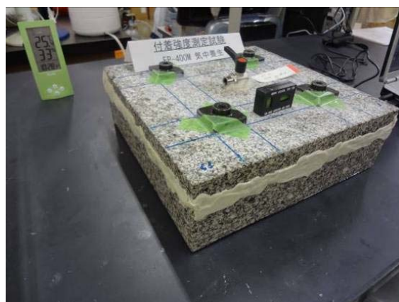
④ レジンの流出防止と気中養生状
