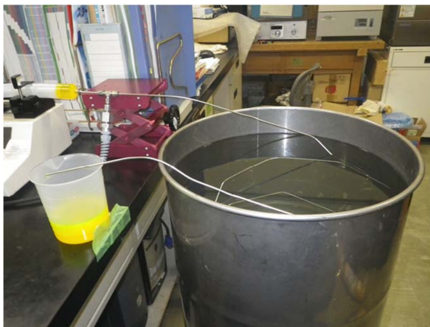
図 4.3.1-1 一次元流動試験で用いた鋼管の温度管理状況
