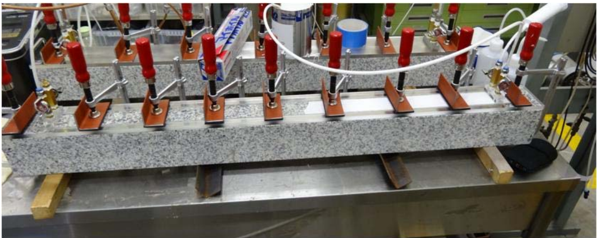
(1) レジンの注入状況（白色部分がレジン）
