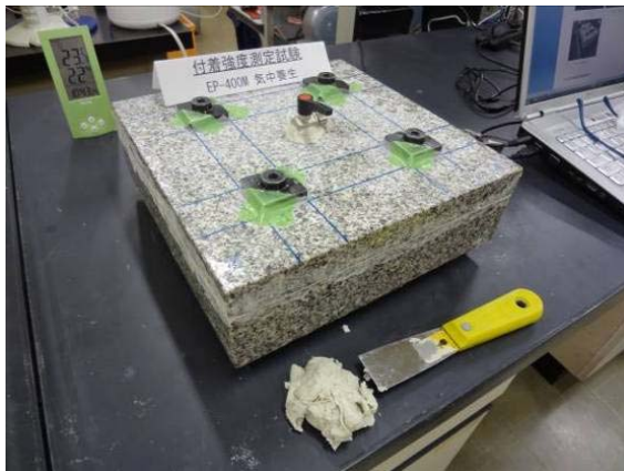
① レジン流出防止用パテの取り外し
