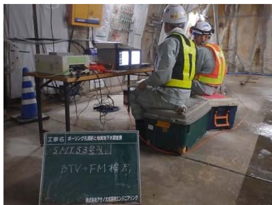
図 5.2.3-34 BTV・フローメータ測定状況
