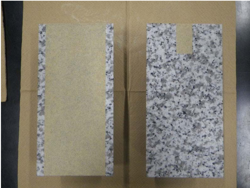
図 4. 3. 2-4 割れ目内及び円孔内の砂の充填状況
