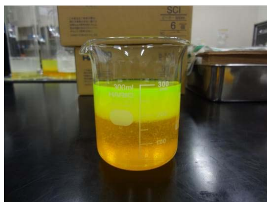
③ レジン投入直後（水+模擬海水）
