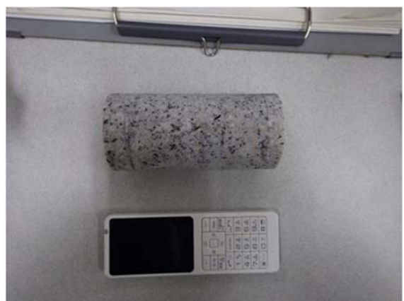
⑥ オーバーコアリング及び端面整形
