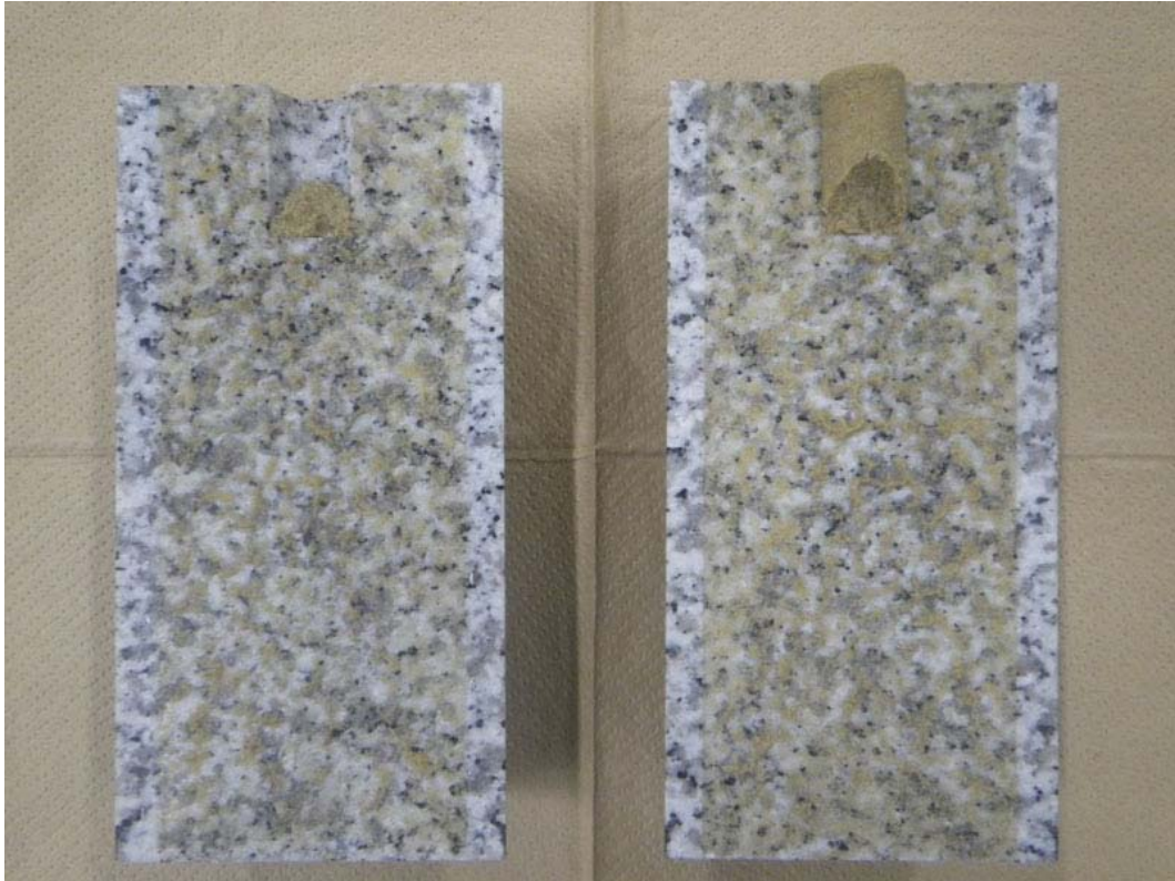
図 4.3.2-6 水注入後の割れ目内部の状況写真
