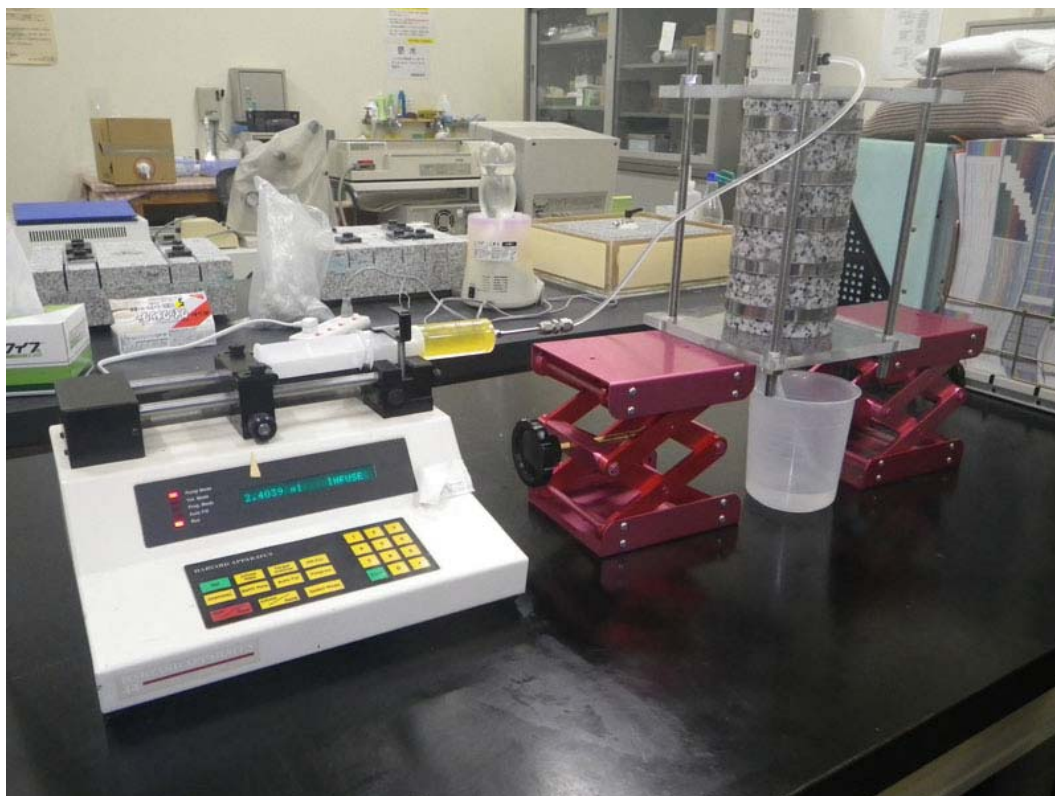
図 4.3.2-5 レジン注入試験の状況写真
