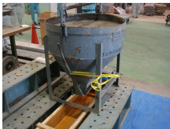
(b) コンクリートホッパー外観
