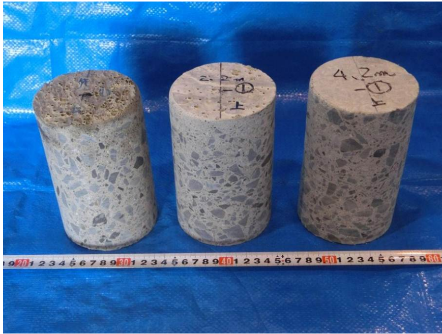
図 5.2.2-17 水平方向打設試験体より採取したコアの外観写真 (左から、流動先端位置、流動先端から 2.2m、流動先端から 4.2m)
