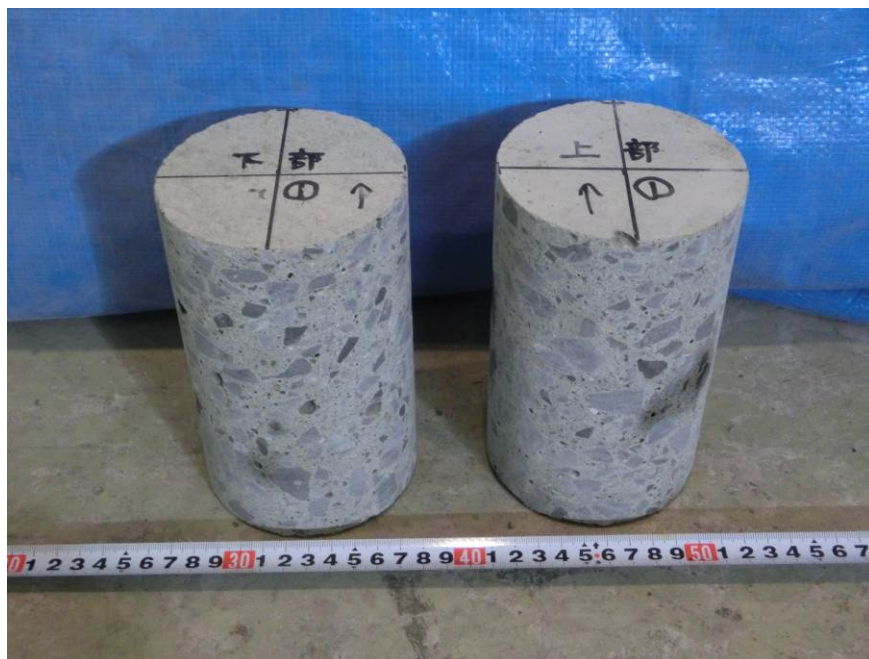
図 5.2.2-18 垂直方向打設試験体より採取したコアの外観写真 (左側が下部、右側が上部)
