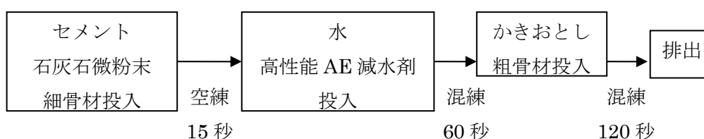
図 5.2.2-12 コンクリートの練混ぜ方法
