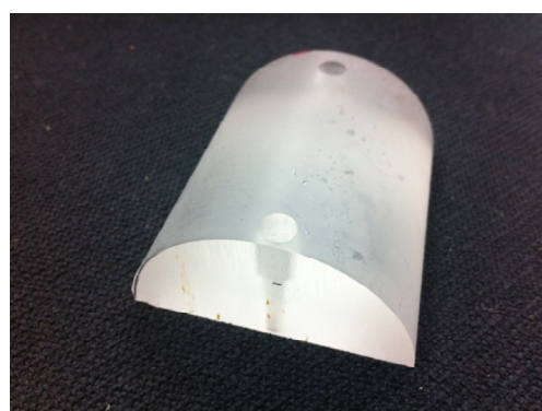
図 5.3.3-4 フォーカスクさびの設計図と試作したくさびの外観写真
