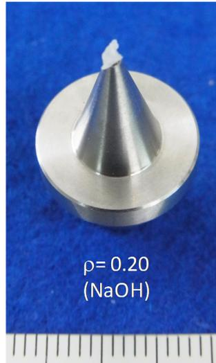
図 4.1.1-22 SWN ヘクトライトの密度 0.20 試料( $\mu$ -XRD 測定試料)
