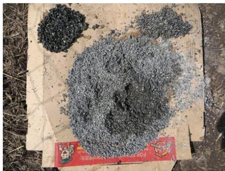
図 2.3.1-3 DH10 孔の孔壁崩壊箇所で大量に出た砂状スライム
