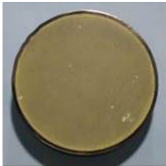
図 2.2.2-1 アルミナ固化体の外観
