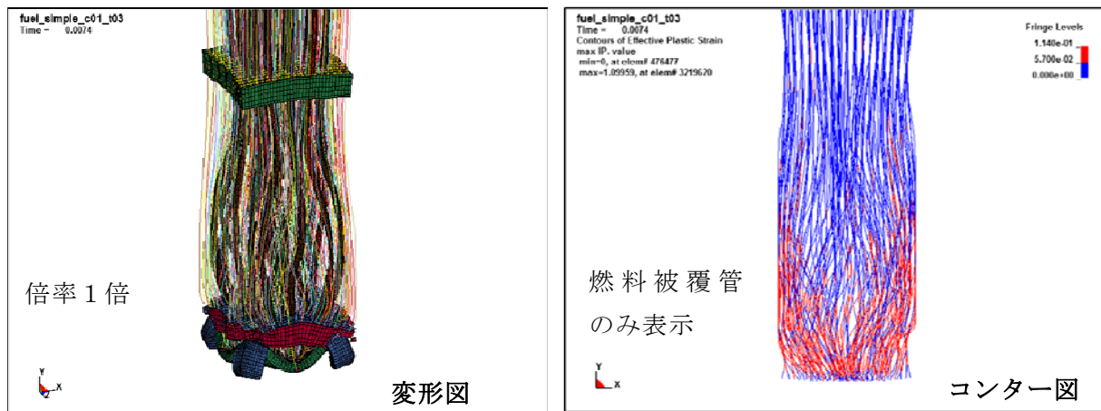
図 4.2.2-40 燃料集合体の変形図および塑性ひずみコンター図
