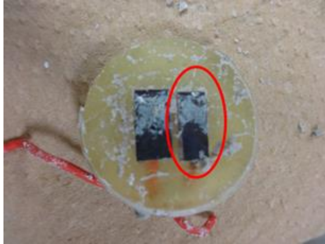
図 3. 2. 2-17 ベントナイト中から取り出した銅電極
