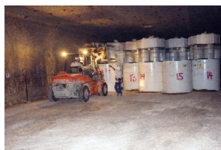
▲ 廃棄物定置状況
