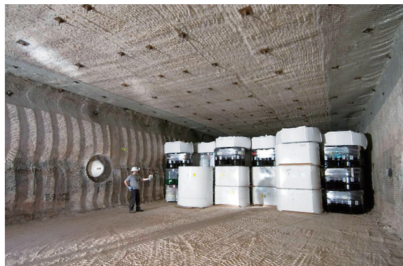
廃棄物隔離パイロットプラント（WIPP）での廃棄物定置状況 (DOE WIPPウェブサイトより引用)
