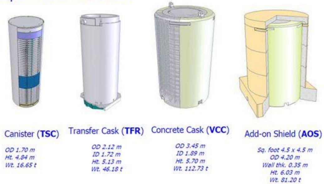
図 3.1-6 INER-HPS キャスクの概要
