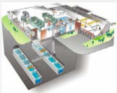
CLINKの概念図 (SKB社資料より引用) ※使用済燃料の中間貯蔵施設 (CLAB) は1985年から操業しており、高圧水圧力、地下にある2つのプールとこの建屋に組み込まれている。図の右側の建屋が新たに建設予定のキャニスタ封入施設であり、これを2施設を一体でCLINKと呼ぶ。
