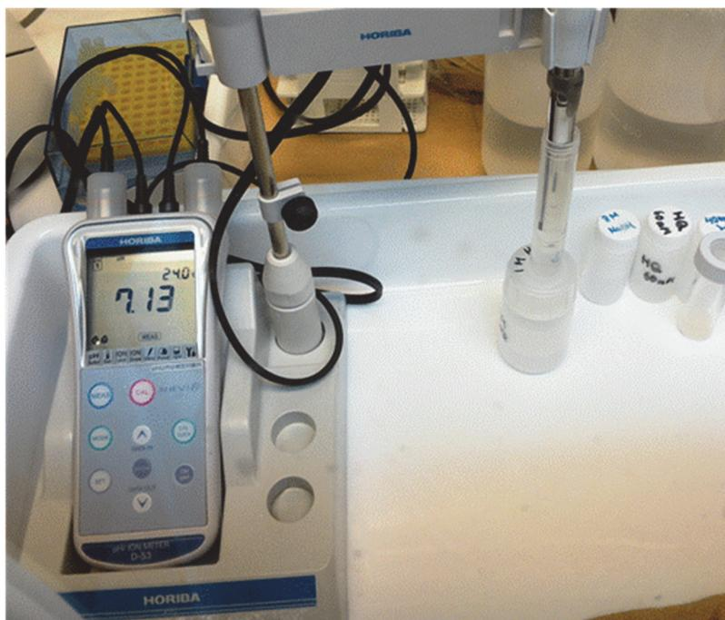
図 9 高イオン強度下における pH 測定
