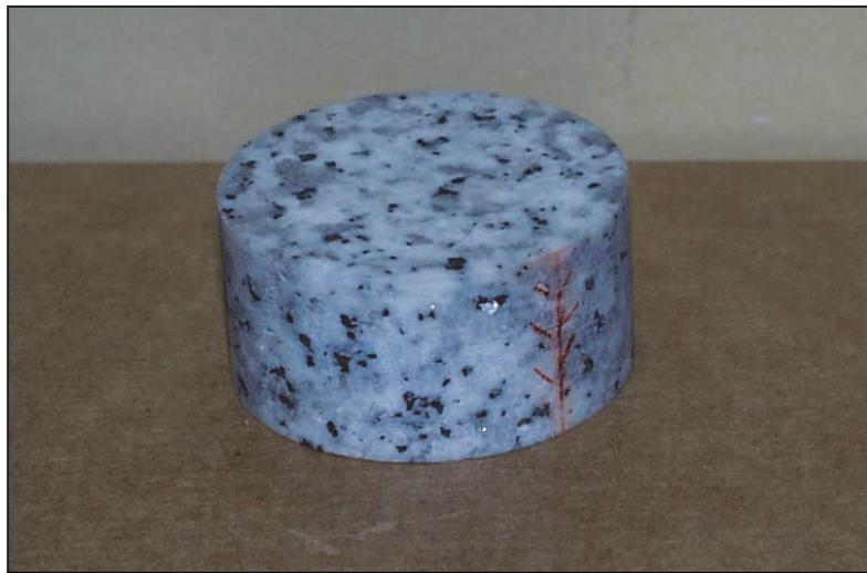
図 1 8 稲田花崗岩の透水試験片の写真
