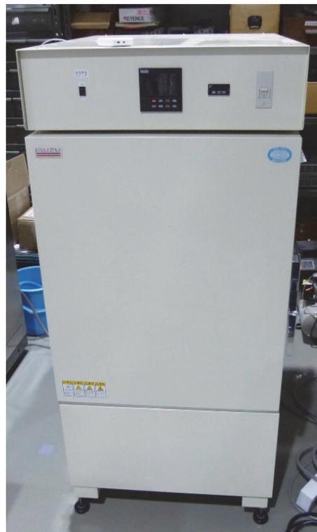
図6 DT 試験装置を設置した恒温槽の概観 (高さ 1445mm)
