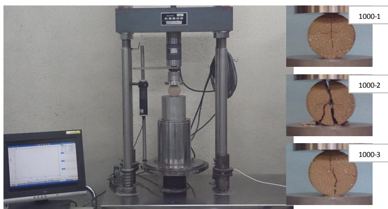
図 4.3.4-10 試験状況 (試験ケース 1000°C)
