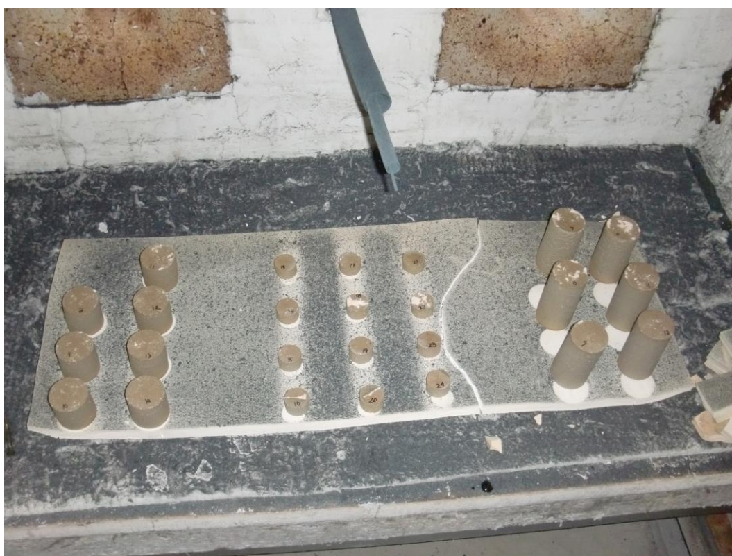
図 4.3.4-4 加熱後の試験体の試験体状況 (加熱条件 1000°C)
