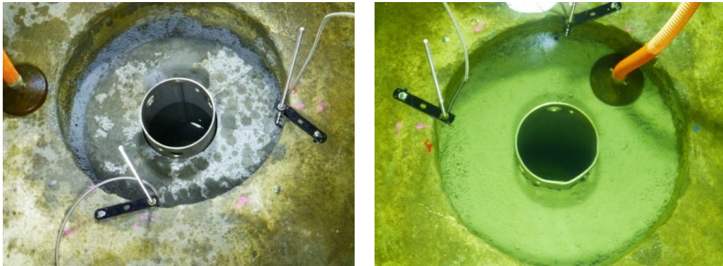
図 12.4.1-7 緩衝材ブロック 6 段+ペレット (4mm+0.3mm)、地下水流入量 (7L/分→2L/分)
