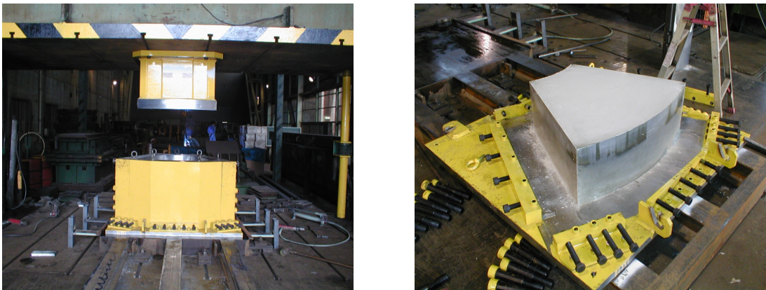
図 12.2.2-1 左 実規模 1/8 分割ブロック成形装置
