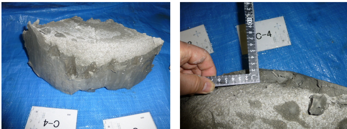
図 12.1.2-1 緩衝材ブロックとペレットが一体化した状況（C-3,C-4ブロックの浸潤後1か月）
