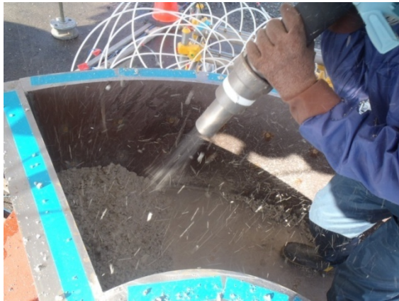
湧水量 0.1L/分の状況で吹付け施工（堆積岩を模擬）
