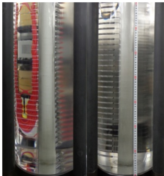
写真 5.1.5-1 液体の浸潤状況（左：蒸留水、右：NaCl 水溶液（0.5M））
