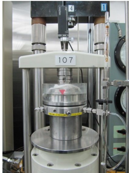
図 3.6-5 圧密試験装置 (Case1)
