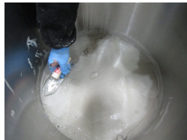
試料敷均し状況
