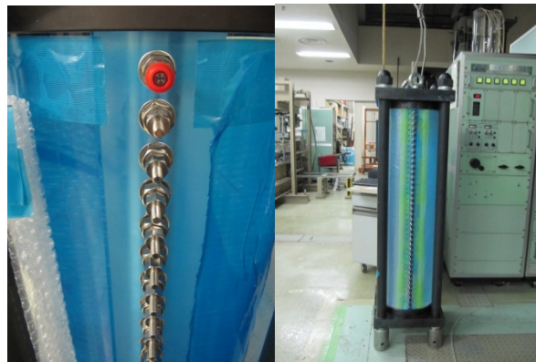
図 5.1.3-4 比抵抗測定用電極の設置
