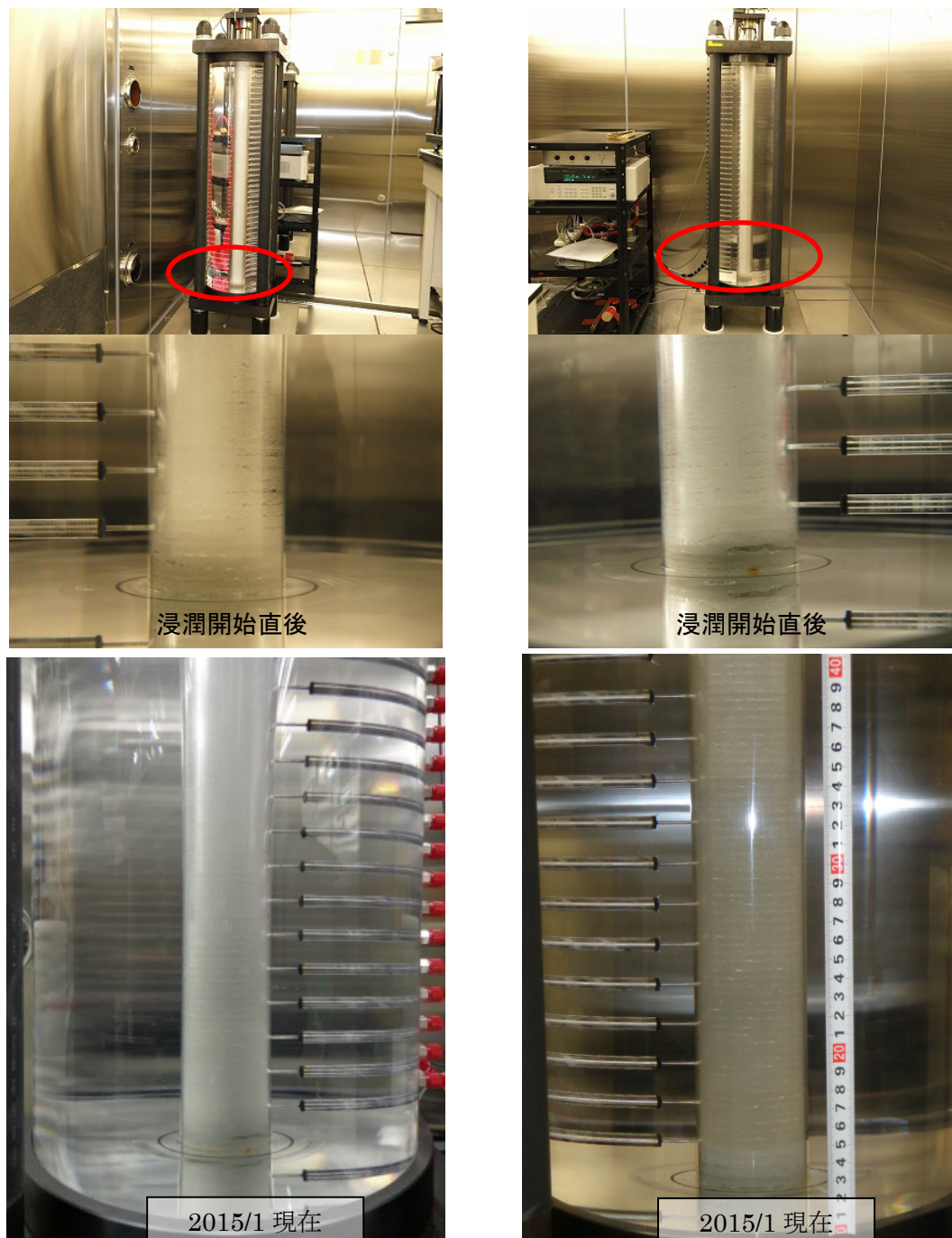
図 5.1.5-3 液体の浸潤状況（左：蒸留水、右：NaCl 水溶液（0.5M））
