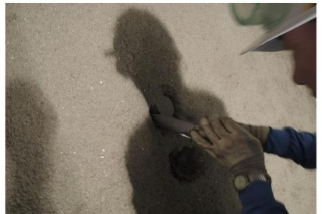
図 3.2-2 供試体採取状況（吹付け施工後）
