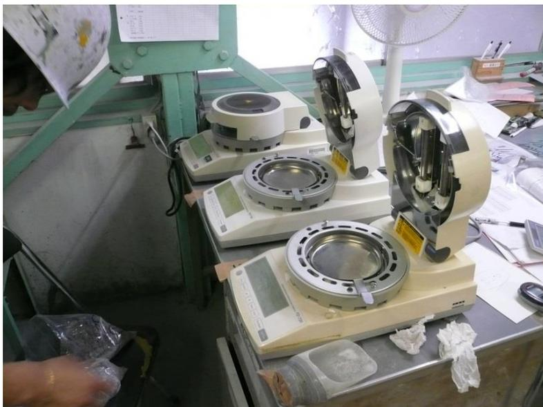
図 2.1-18 調整後含水比測定状況
