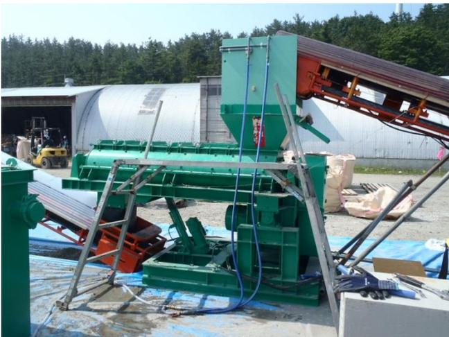
図 3.1-21 二軸強制ミキサ (加水混合用)
