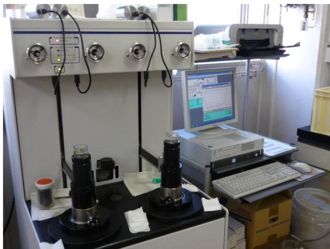
図 5.2-8 水銀圧入試験装置
