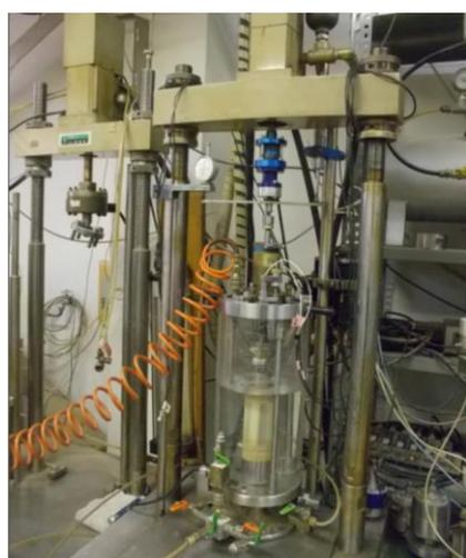
図 4.3-1 三軸圧縮試験装置
