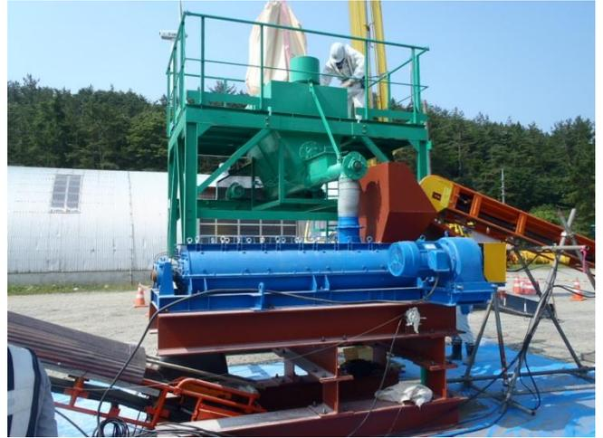
図 3.1-20 二軸強制ミキサ (混合用)
