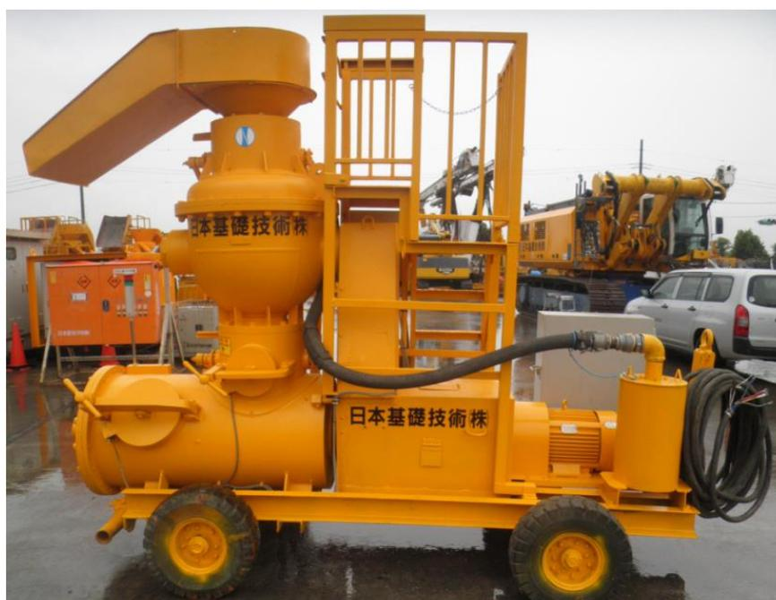
図 3.1-12 圧力釜式吹付け機
