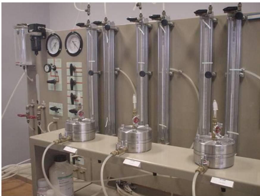
図 2.2-27 透水試験装置
