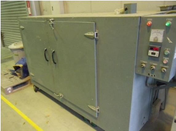
図 4.6-12 恒温乾燥炉
