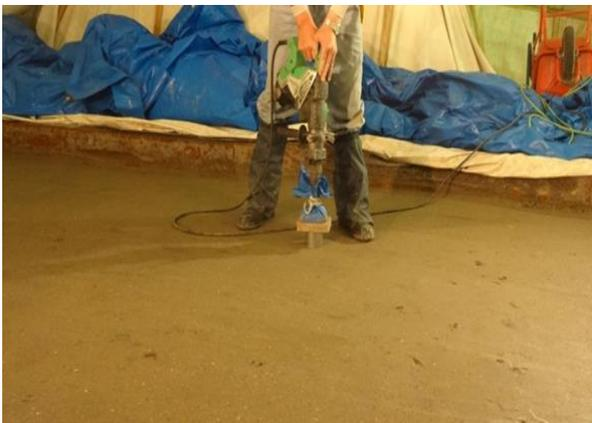
図 3.2-1 供試体採取状況（転圧施工後）
