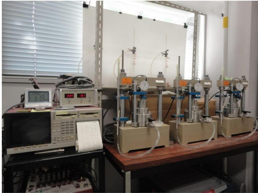
図 3.2-27 膨潤圧試験装置
