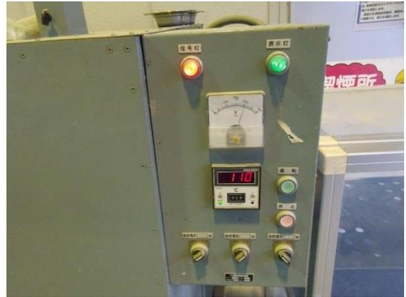
図 4.6-13 恒温乾燥炉の表示温度
