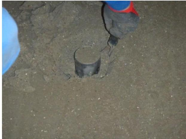
図 3.1-44 シンウォールサンプラーによるコア採取状況
