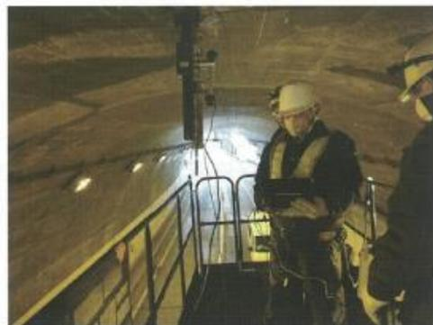
(a) 覆工応力測定技術 (b) 空洞形状計測装置
