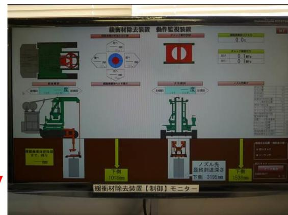
噴射・吸引設備の動作制御
