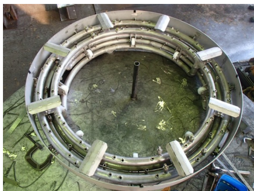
図 2.1.2-4 塩水噴射・スラリー吸引装置の製作状況
