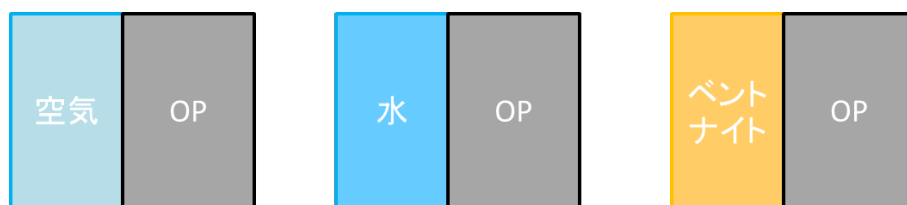
図 2.3.2-19 腐食評価の観点から埋戻状態(模式図)
