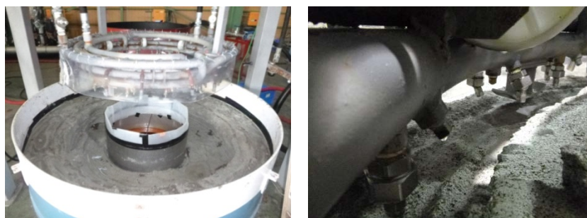
図 2.1.9-3 塩水噴射・スラリー吸引装置の機能確認 (平成 24 年度)
