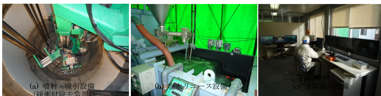
図 2.1.9-11 緩衝材除去による各設備の機能確認（平成 25 年度）
