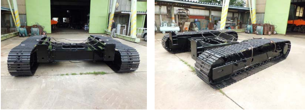
図 2.1.2-12 走行部製作状況
