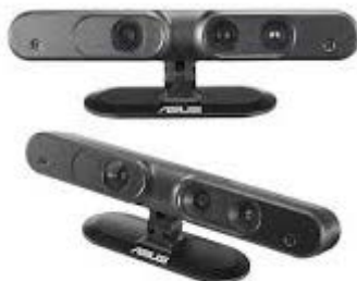
図 2.1.4-6 3D 観測装置（Xtion）の形状
