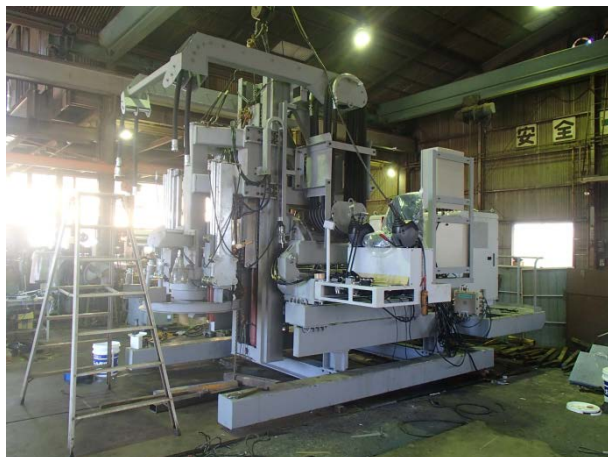
図 2.1.9-4 昇降装置・把持装置を含む緩衝材除去装置ベース部の組立（平成 24 年度）
