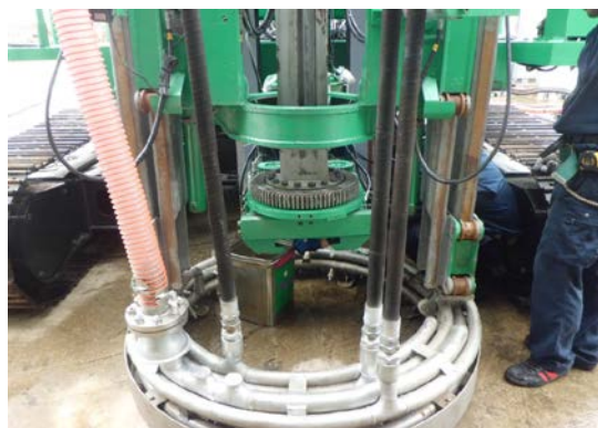
図 2.1.2-4 塩水噴射・スラリー吸引装置の製作状況
