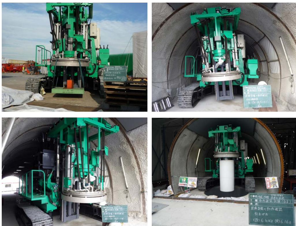
図 2.1.5-4 昇降装置の動作確認試験状況
