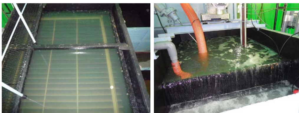
図 2.1.5-10 塩水リユース設備の動作確認試験状況
