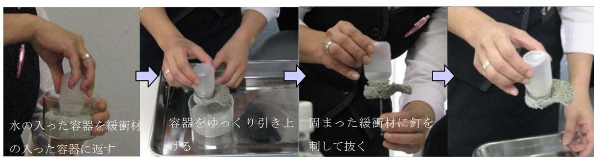
図 2.3.5-1 緩衝材の止水実験の方法
