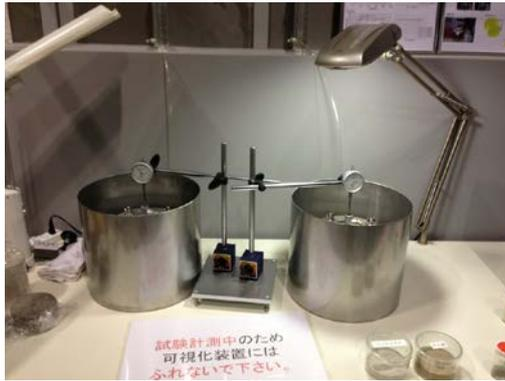
図 2.3.4-4 水平方向の隙間の浸潤試験状況
