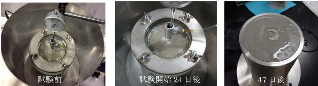
図 2.3.4-5 緩衝材可視化試験状況 (Case1)
