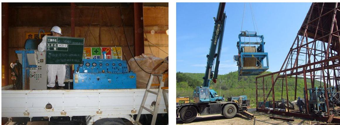
図 5.1.4-1 試錐機操作盤・掘削用アーマードケーブルウインチ搬出状況
