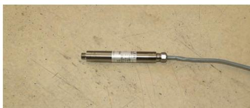
図 6.1.1-2 スタンドパイプ内圧力センサー
