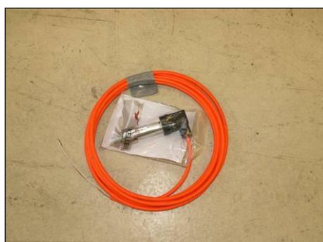
図 6.1.1-3 パッカー圧計測センサー
