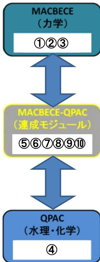
付録図 3-1 連成解析における方程式とパラメータ群の構造
