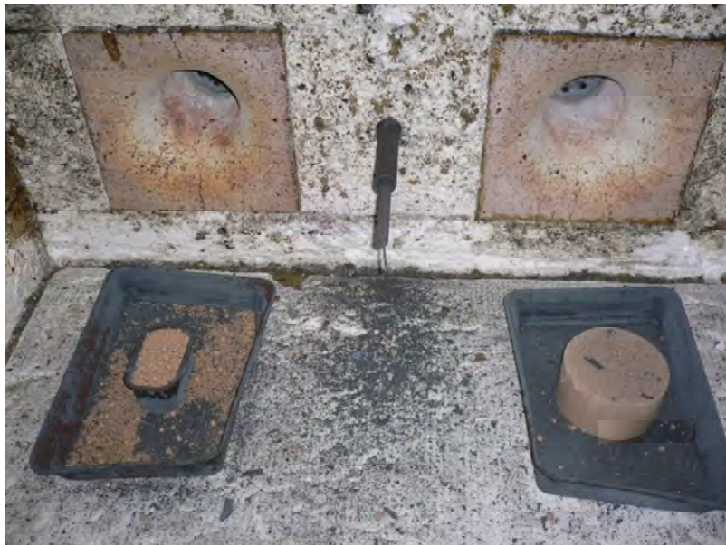
図 4.3.3-4 加熱後の供試体の状況（左：P10 供試体右：B10 供試体）
