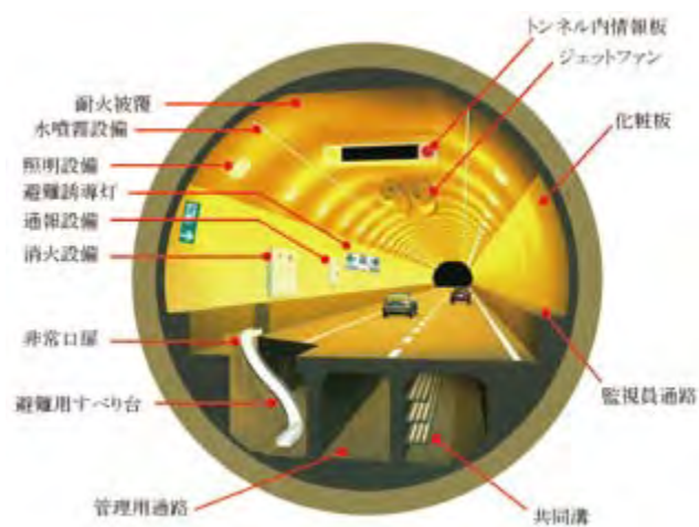
図 3.2.2-6 東京湾アクアライントンネル部の断面
