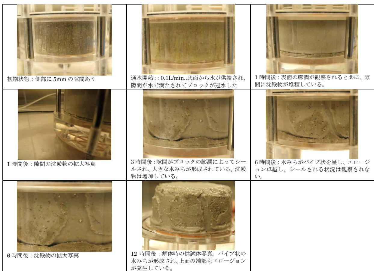
図 6.1.3-6 注入口:底面/蒸留水/ブロックケースのパイピングとエロージョンの発生状況
