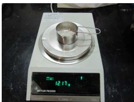
図 5.1.3-1 5mm 撒き出し分のベントナイトの計量
