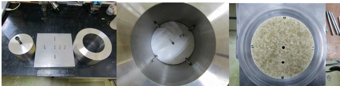
図 6.1.4-5 人為的な水みちを有する供試体作製状況
