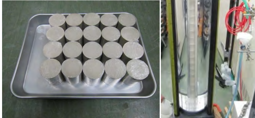
写真 6.2.3-1 モンモリロナイトブロック (左) を積み上げた 1000mm ブロック供試体(右)
