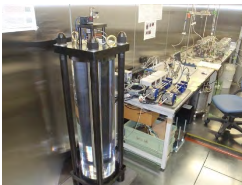
図 6.2.2-1 パイピング生成試験機全景
