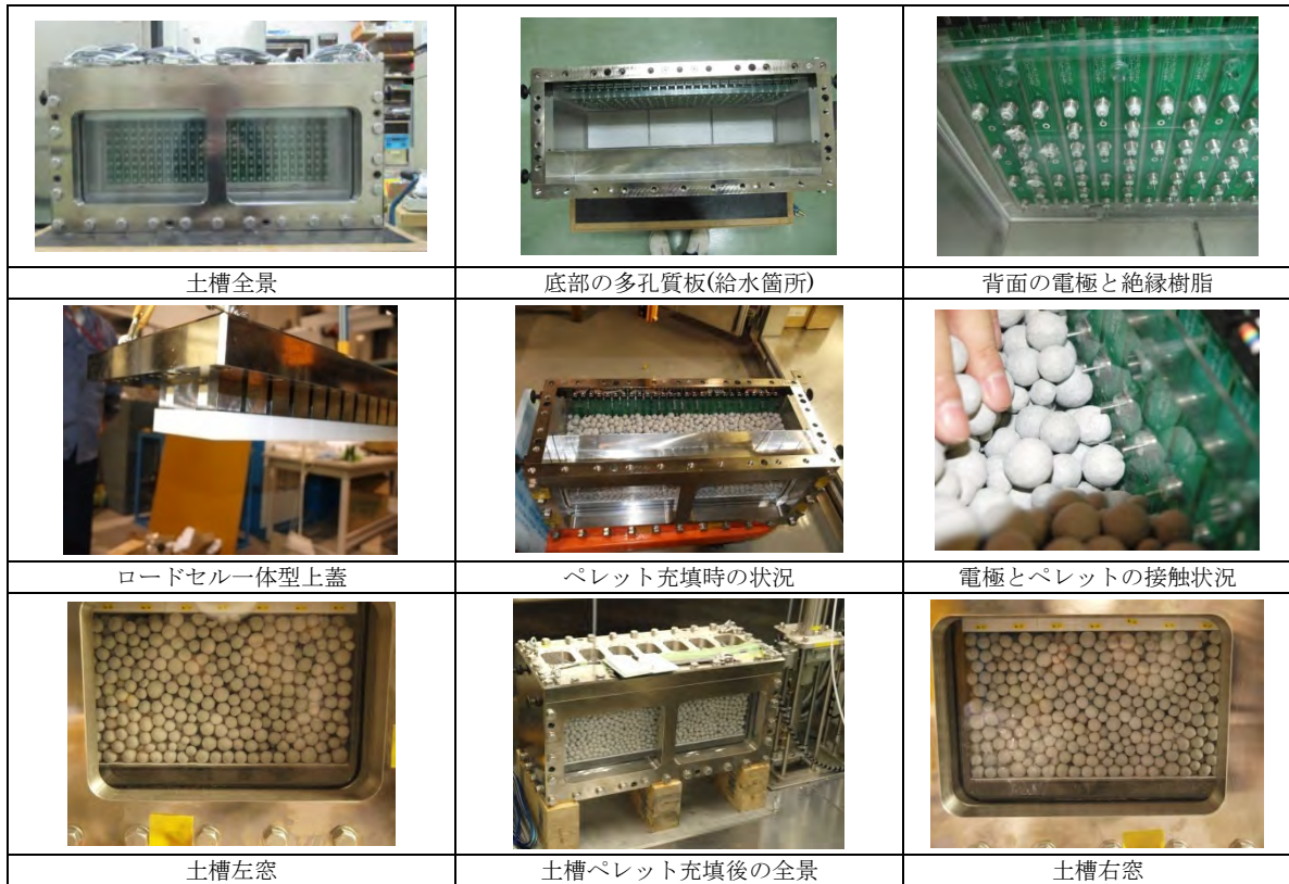
図 7.1.3-1 ペレット充填ケースの土槽試験手順
