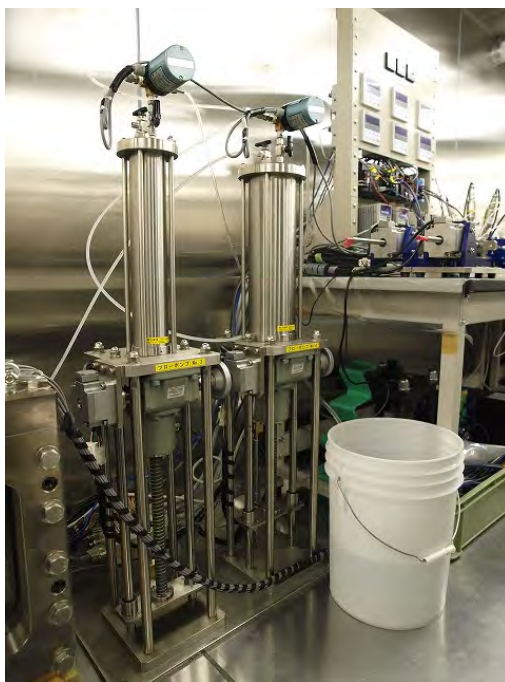
図 6.1.3-4 2連シリンジポンプによる定流量制御装置
