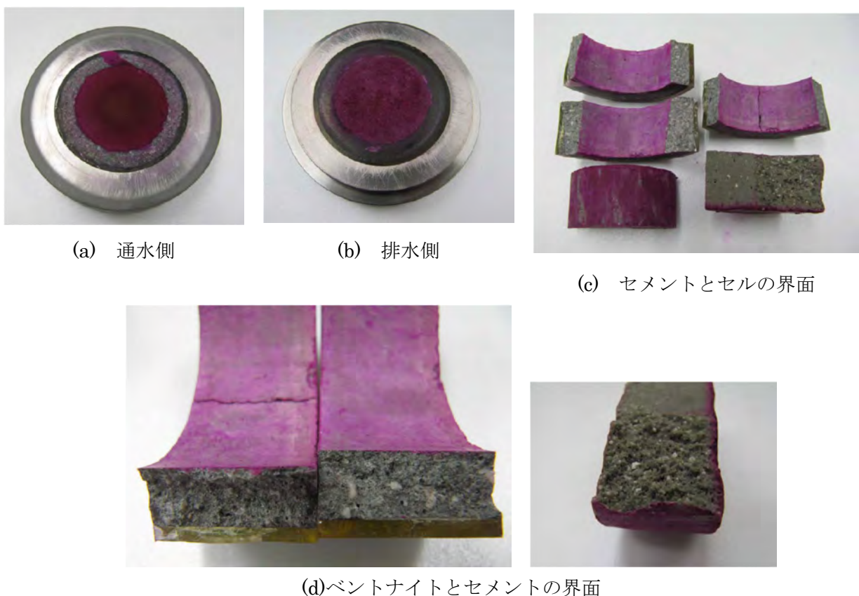
図 6.1.2-11 ローダミン注入後のベントナイト/セメント供試体
