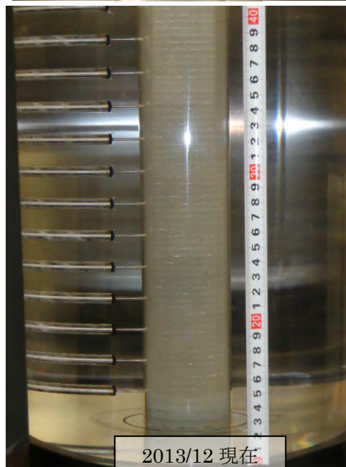
図 5.1.5-7 液体の浸潤状況（左：蒸留水、右：NaCl 水溶液（0.5M））
