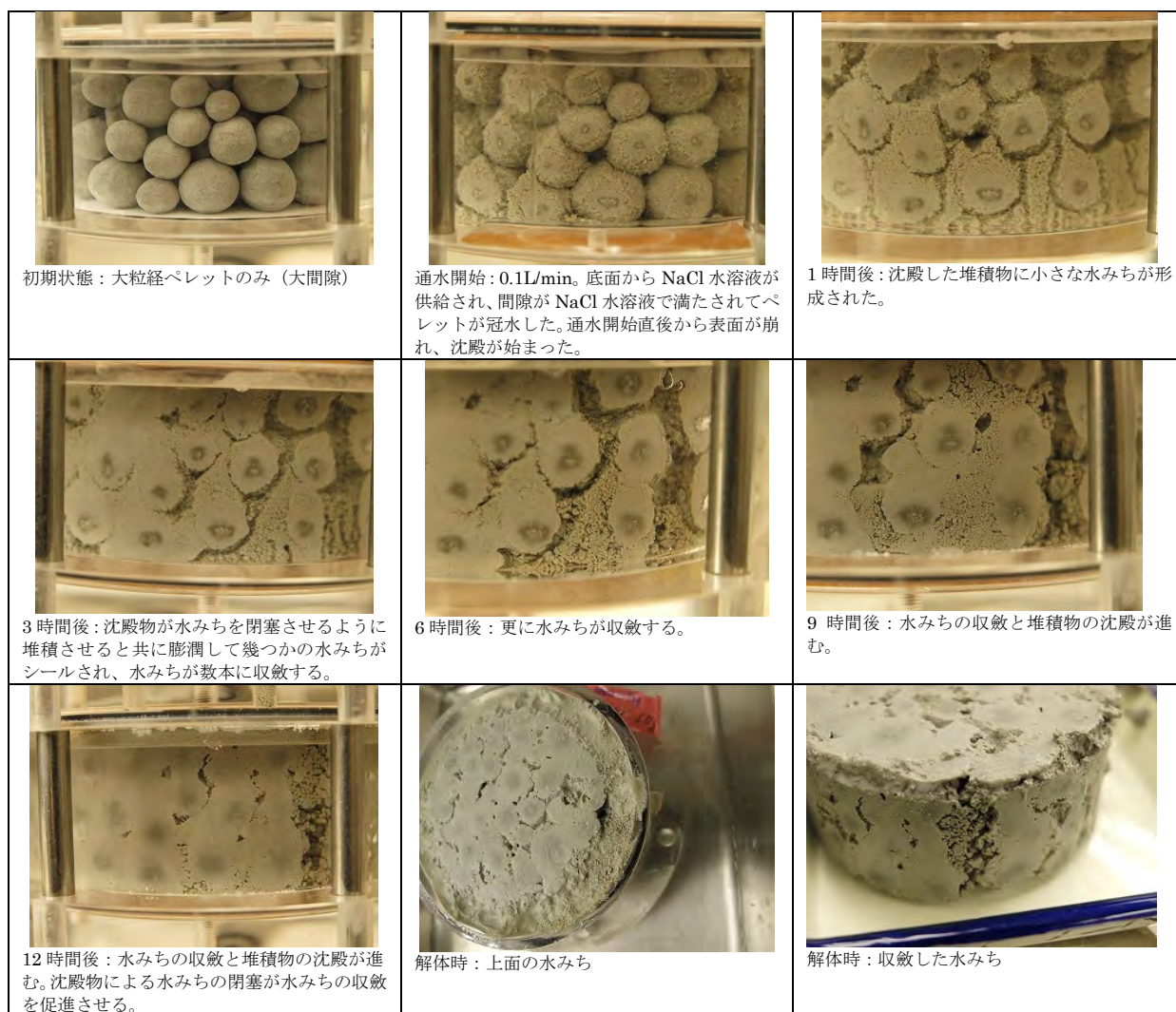
図 6.1.3-11 注入口:底面/蒸留水/大粒径ペレットケースのパイピングとエロージョンの発生状況
