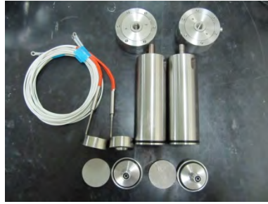
図 5.1.3-7 ヒーター付きピストン
