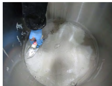
試料敷均し状況
