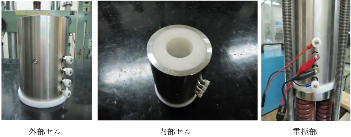
図 5.1.4-2 飽和度と比抵抗の関係取得試験装置
