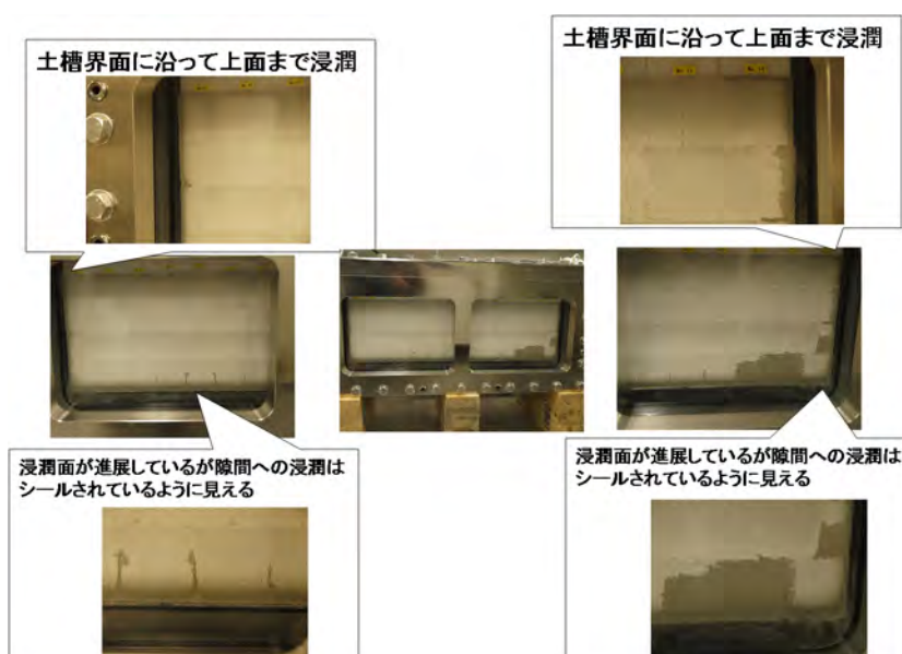
図 7.1.4-10 再冠水状況／ブロック定置ケース／給水開始 4 日後
