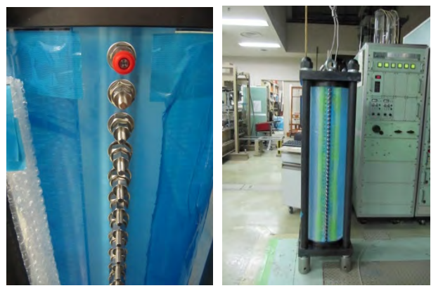
図 5.1.3-4 比抵抗測定用電極の設置
