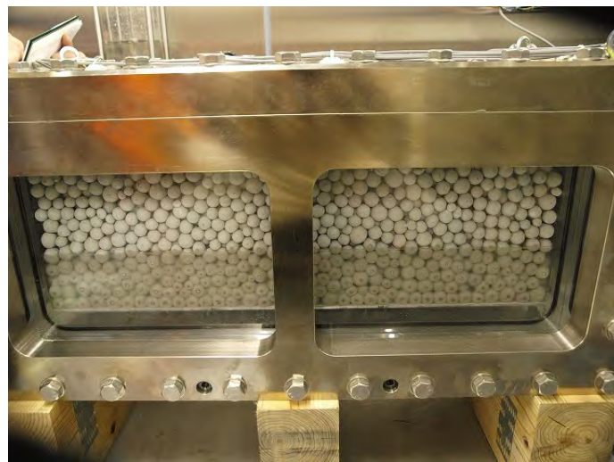
図 7.1.3-2 再冠水状況/ペレット充填ケース/給水開始 20 分後
