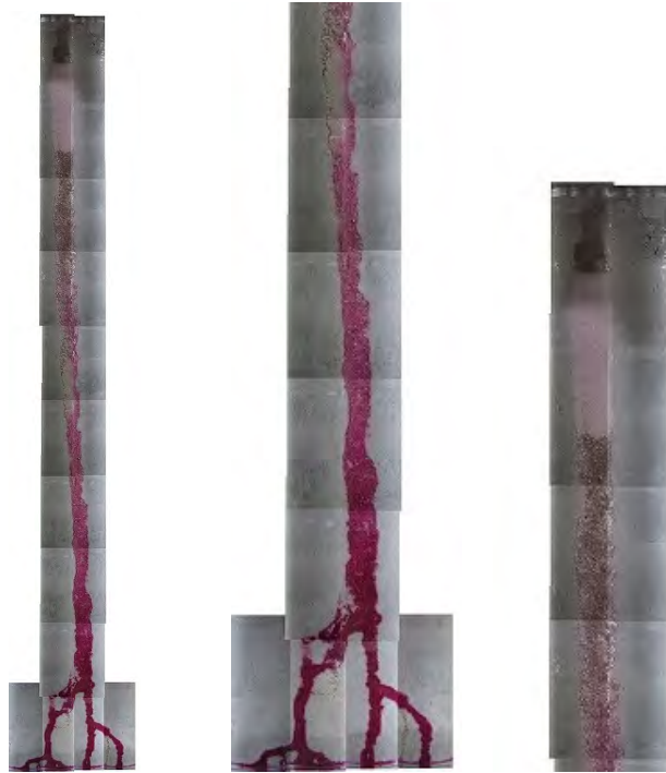
図 6.2.3-15 1000mm セルによるパイピング試験の水みち観察(H24)
