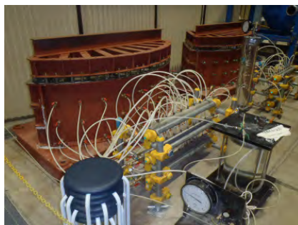
写真 9.3.3-1 緩衝材への給水状況
