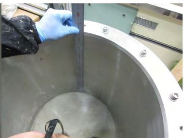
残尺測定状況
