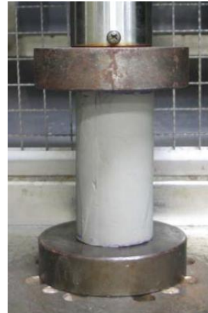
図4. 3. 3-8 一軸圧縮試験装置の一例と実施状況
