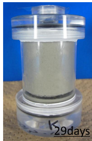
図3. 2. 4-4 塩化アンモニウム通水実験開始後29日の供試体 (乾燥密度 0.6 \text{ Mg/m}^3 、通水開始29日後)
