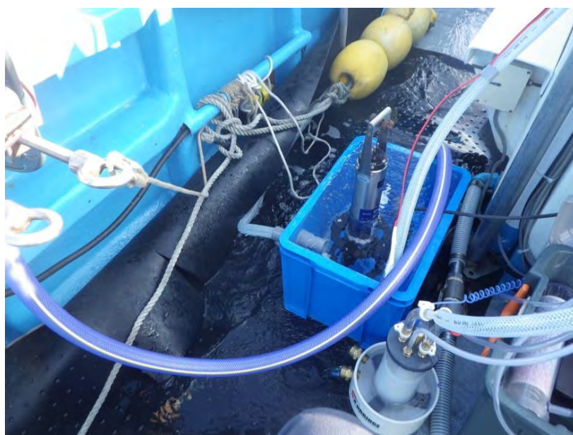
図 4-1-2 水温、電気伝導度、塩分、D O 、Chl-a の測定状況 (青色コンテナボックス内に多項目水質プロファイラーを設置)
