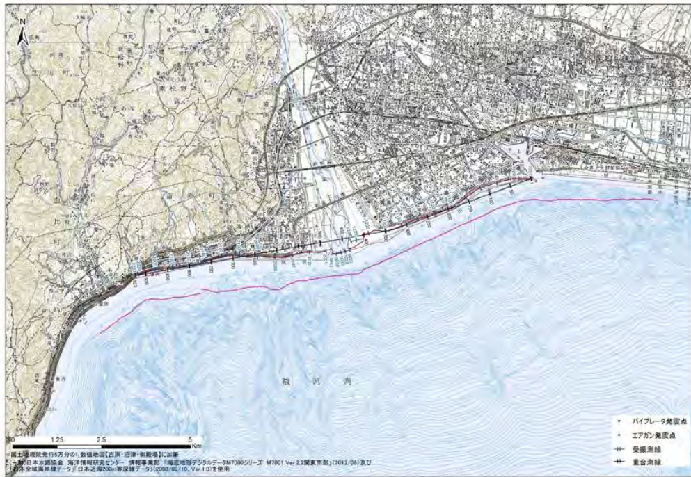
図3-1-2 調査測線位置図[受振点,発震点及びCMP重合測線]
