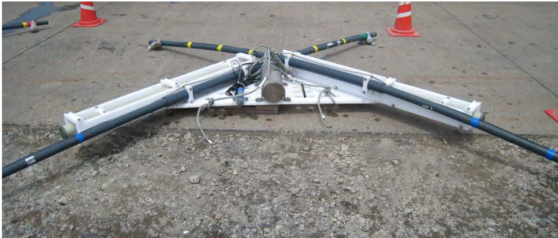
図3-2-2-2 浅海域用海底電磁探査法装置 (Ueda et al. (2014)より)
