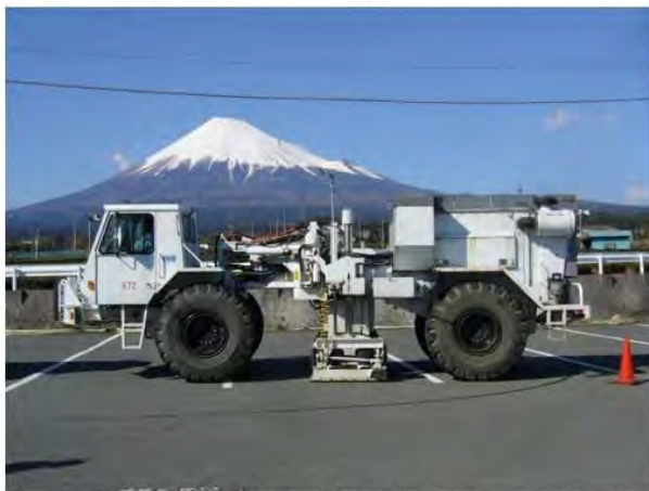
図3-1-4 陸域震源(パイプロサイス車)
