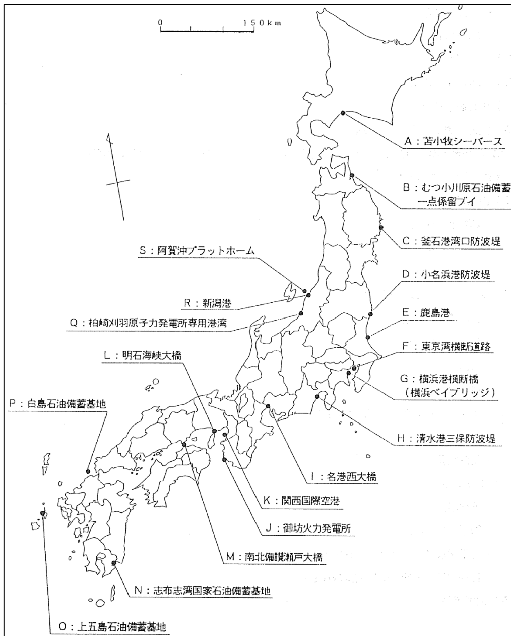
図 4.2.4 日本の大規模な海洋模構造物と基礎地盤調査の実施地点 (本荘ほか, 1994) 本荘ほか (1994) によって大型電力構造物の第四紀地盤人工島立地の検討に際して大規模な海洋構造物と海上調査に関わる文献調査が行われた事例である。海洋構造物を対象とした海上掘削調査の事例としては、青函トンネル (前田ほか, 1983 ; 前田, 1988) ・新関門トンネル (吉川, 1975) ・豊予海峡 (吉川ほか, 1980) といった海底トンネルや東京国際空港 (渡部ほか, 2008 ; 2009) ・中部国際空港 (豊蔵ほか, 1999) などが知られる。
