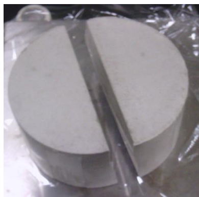
図 2.3-5 ブロック供試体の作製状況
