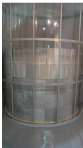
図 2.2-1 模擬処分孔への定置（5 段）
