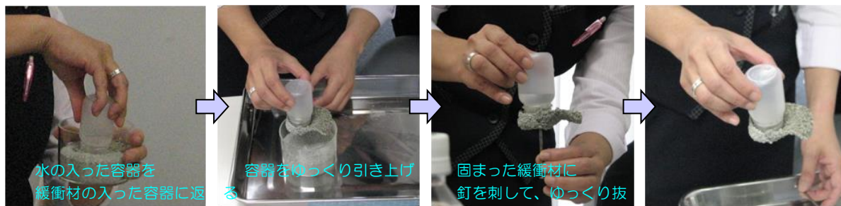
図 2.3-23 緩衝材の止水実験の方法
