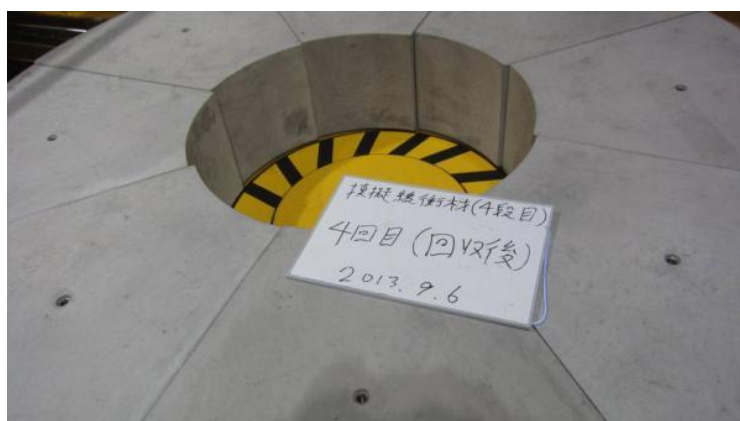
図 2.2-7 定置・回収動作（4 回目）後の模擬緩衝材間のずれ
