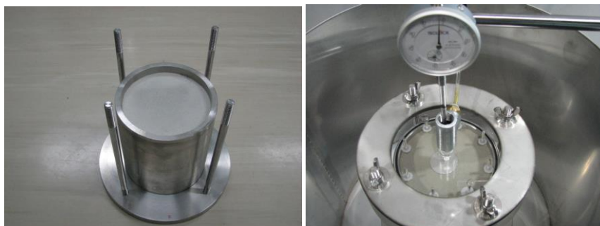
図 2.3-20 試験の準備状況（左：供試体作製、右：隙間および計測機器）
