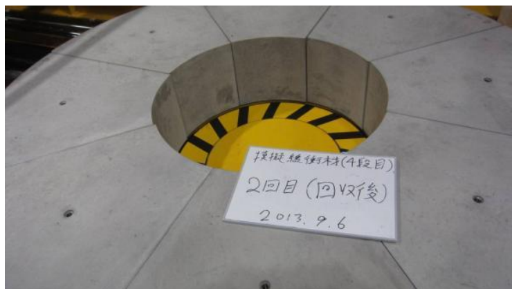
図 2.2-6 定置・回収動作（2 回目）後の模擬緩衝材間のずれ
