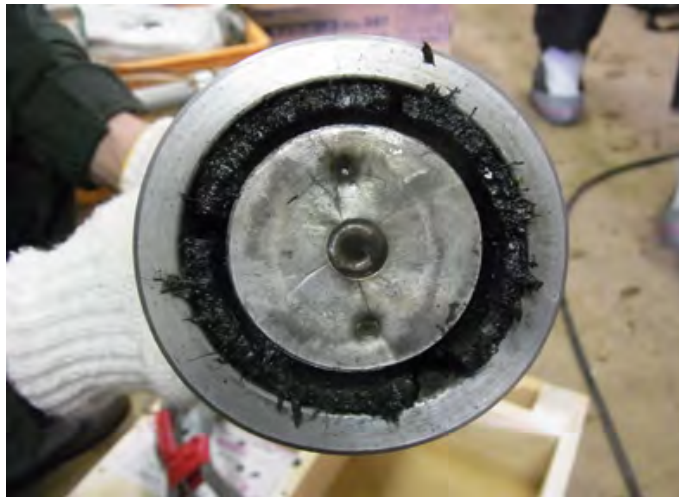
図 8.5.3-6 カプセルの残滓状況
