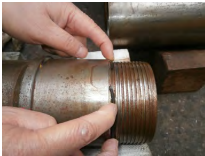
図 8.4.1-14 Oリングの切断
