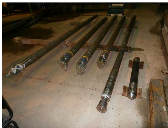
図 8.4.1-1 孔内応力試験装置の搬入時の状態
