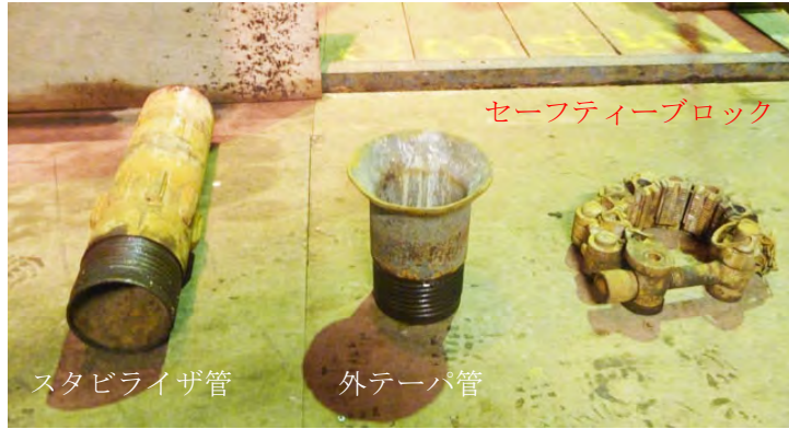
図 8.2.1-1 使用した保護管(NL140 ロッド)の落下防止治具
