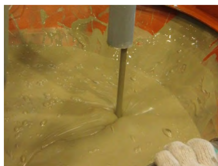
(垂直 2.3m 配管からの流下状況)
