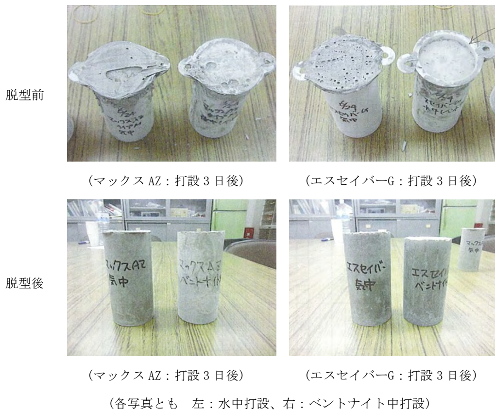
図 5.1.2-3 各ブレミックス材の試験体状況
