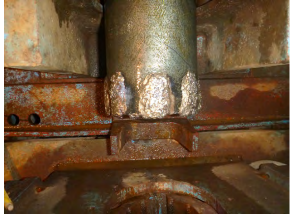
図 8.2.2-18 回収した端面成形用φ152mm コンポジットシュービット
