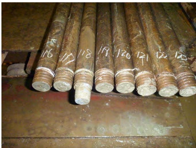
図 8.2.2-10 BQ ロッド管内に残留していたセメントミルク充填材の状況
