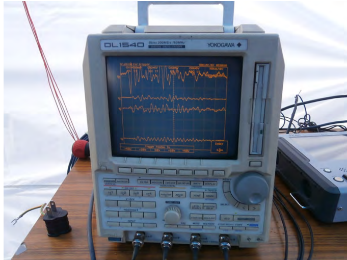
図 6.2.1-15 孔内応力専用ケーブルを介して観測した AE 波形
