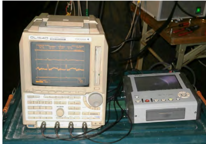
図 8.4.2-16 AE(左)とカメラ(右)の計測状況
