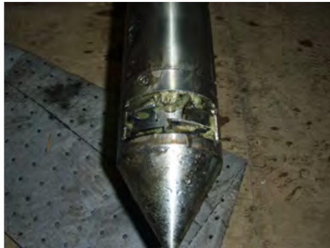
図 8.5.4-7 切断試験後の電動カッター状況(1回目)
