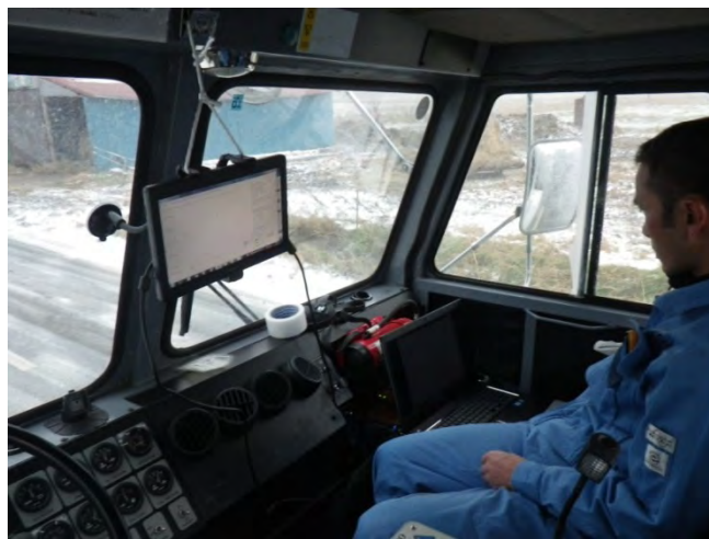
図 7.1.1-7 GPS による大型バイブロサイス震源の発振点への誘導
