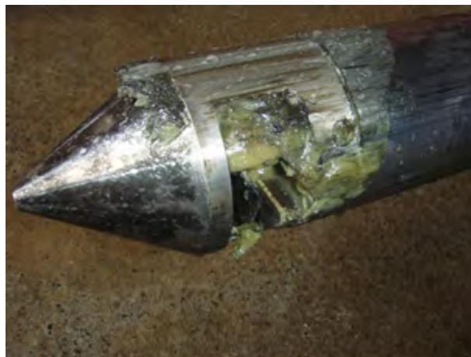
図 8.5.4-12 切断試験後の電動カッター状況(2回目)
