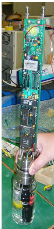
図 6.1.1-12 水質センサ動作確認状況
