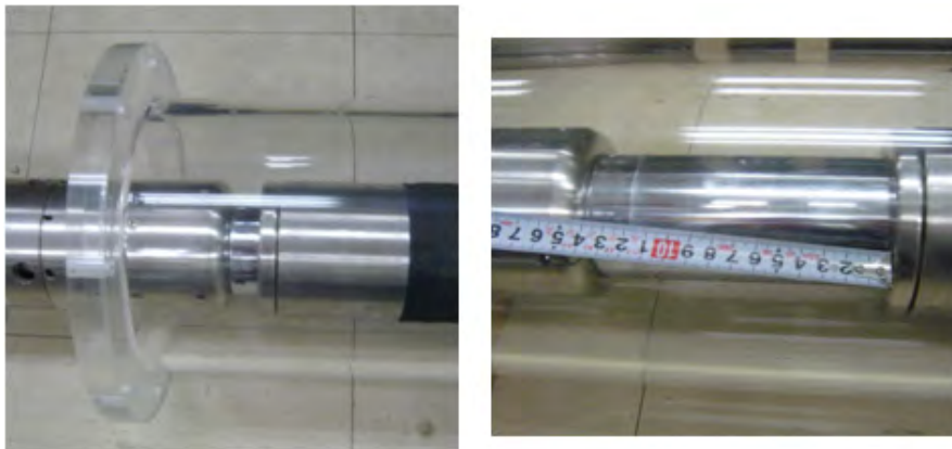
(左図：拡張前(スライド前) 右図：拡張後(スライド118mm))
