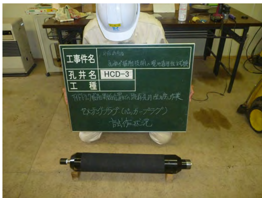
図 5.1.5-2 試作したパッカプラグ
