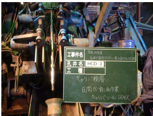
(区間③計測作業：キャリパツール回収)
