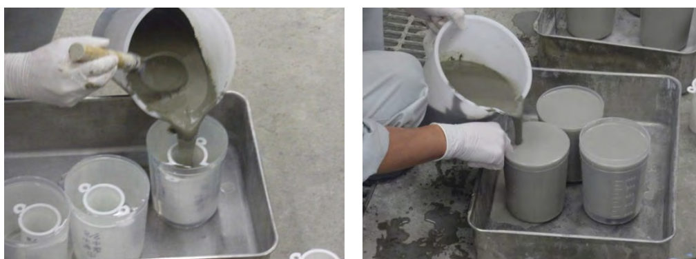
(左：水中への打設、右：ベントナイト水溶液中への打設)
