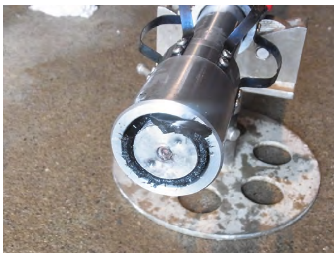
図 8.5.3-7 発破後の装薬治具状況
