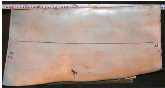
図 8.4.2-11 水圧破碎試験前型どり結果
