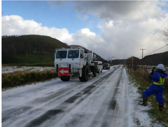
図 7.1.1-2 バイブロサイス震源の路上発振作業(1)
