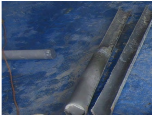
図 5. 1. 2-22 \phi 125mm 塩ビ管垂直方向の充填状況
