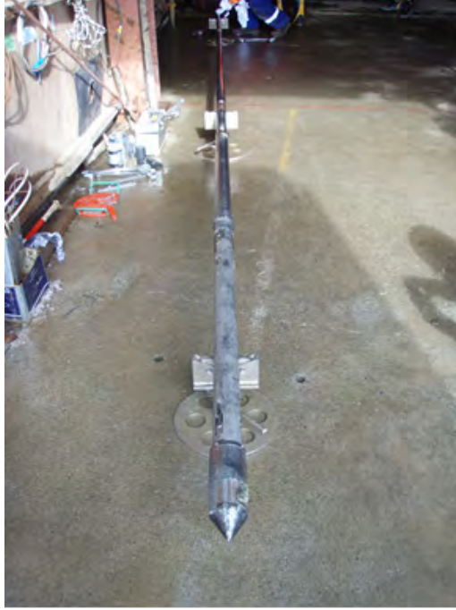
図 8.5.4-9 電動カッター組み立て状況(2回目)
