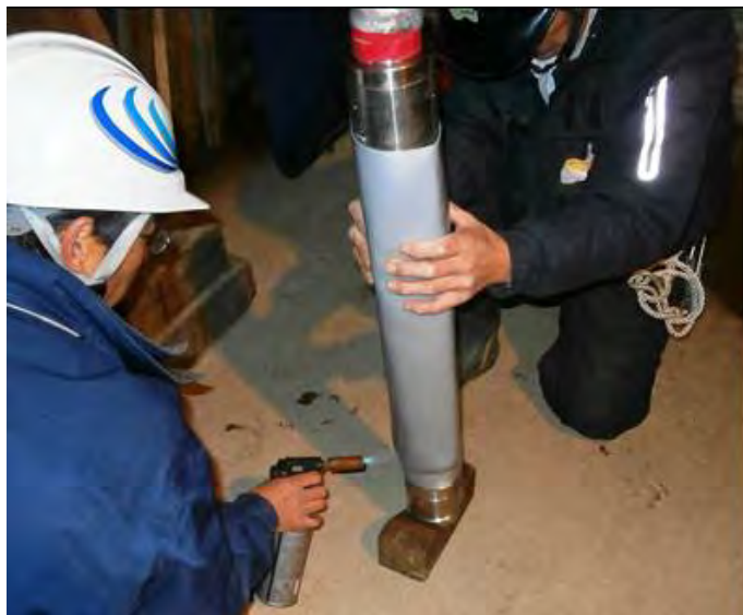
図 8.4.1-4 型どりパッカの作成(熱収縮ゴムチューブ装着)
