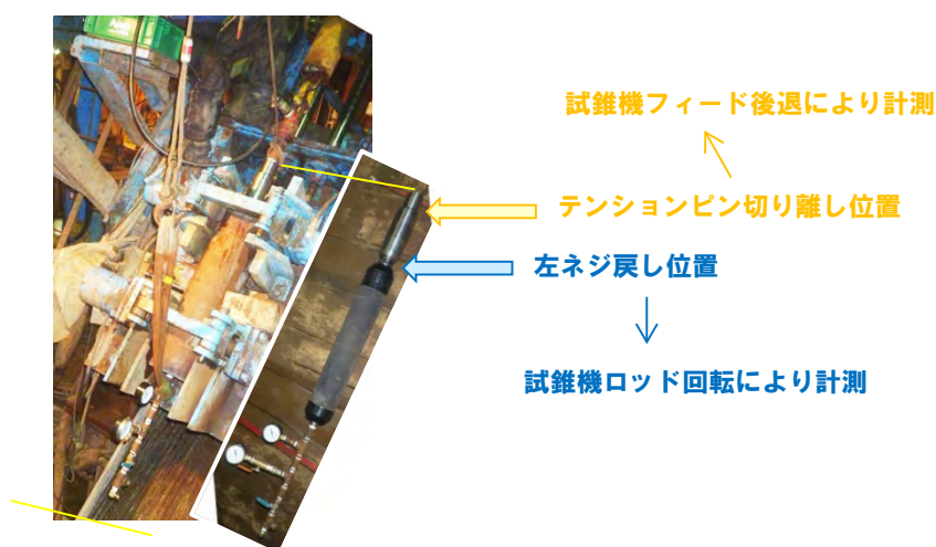
図 5.1.5-10 切り離し治具の作動状況確認試験の概要図
