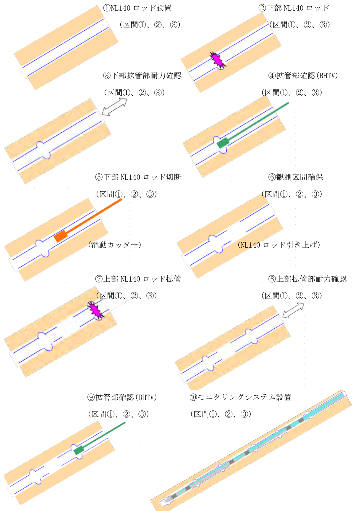
図 8.5. 1-1 HCD-3 孔における現地適用性評価試験の流れ
