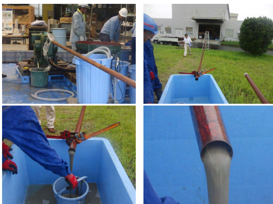
図 5.1.2-19 モルタルポンプを用いた水平方向への圧送性の確認作業状況
