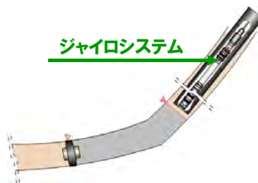
図 5. 1. 4-5 サイドトラック掘削手順概略
