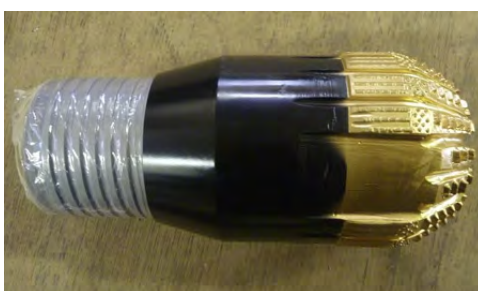
図 8.2.3-3 製作したノンコアリングビット
