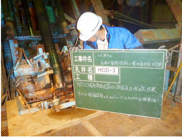
図 8.2.2-18 回収した端面成形用φ152mm コンポジットシュービット
