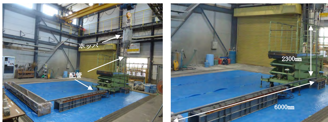
図 5. 1. 2-10 流下状況確認試験の機材配置状況
