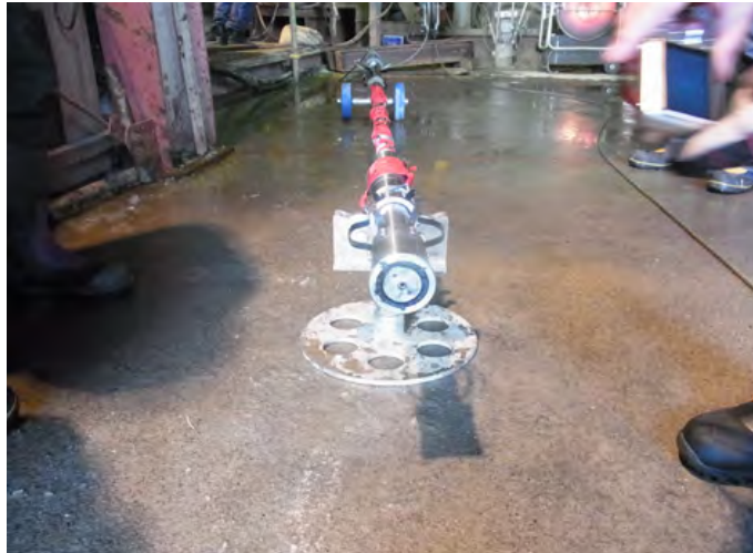
図 8.5.3-5 発破後の装薬治具状況
