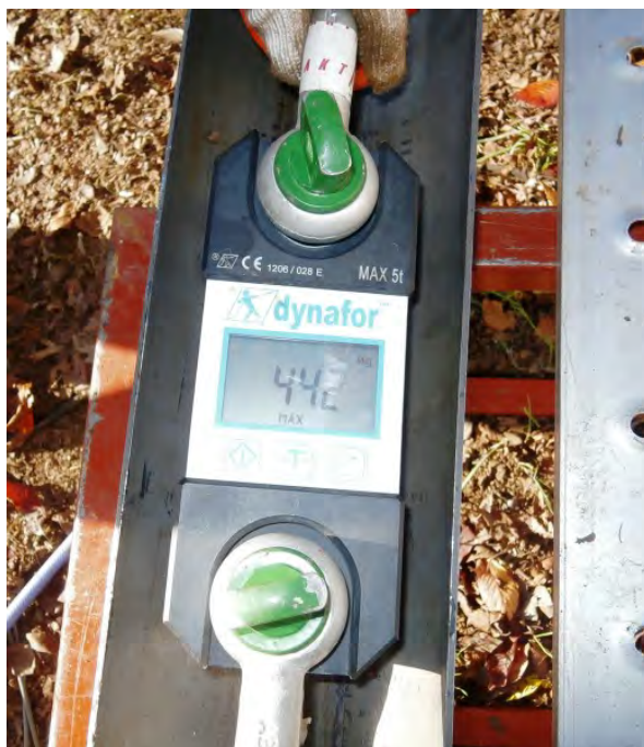
図 6.2.2-12 ラッチ解除荷重計測結果
