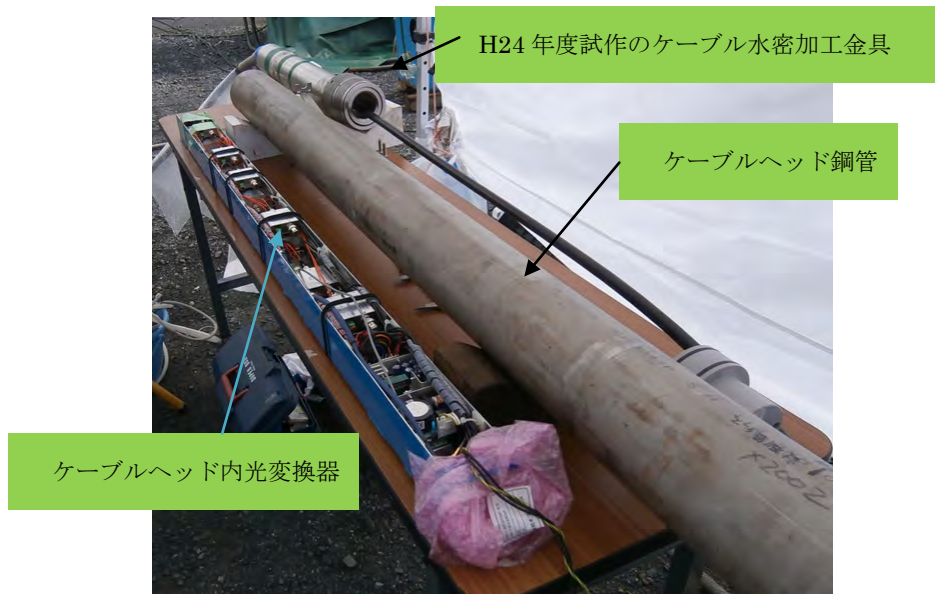
図 6.2.1-1 ケーブルヘッド部組立前状況
