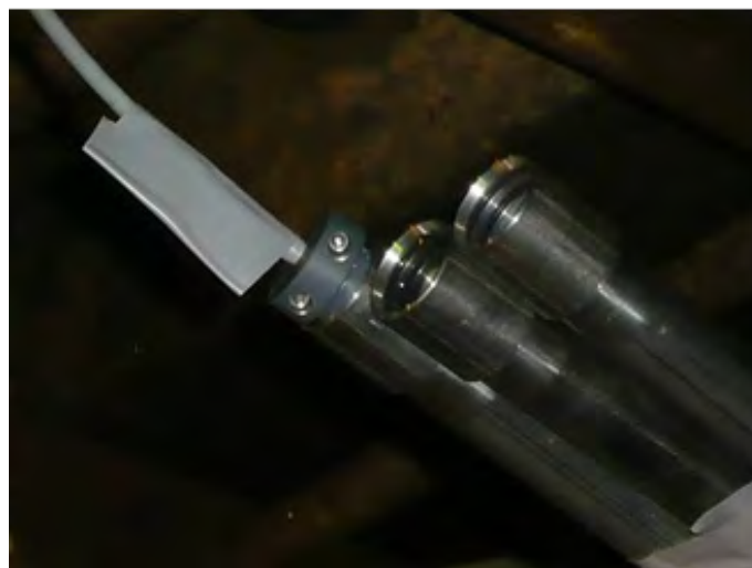
図 8.5.7-16 パッカ拡張に伴いパイプ (GL+0.795m) の口まで達した孔内水
