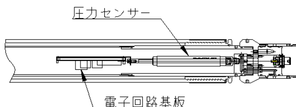
図 6.1.1-3 先端圧力センサ(下部パッカ内)
