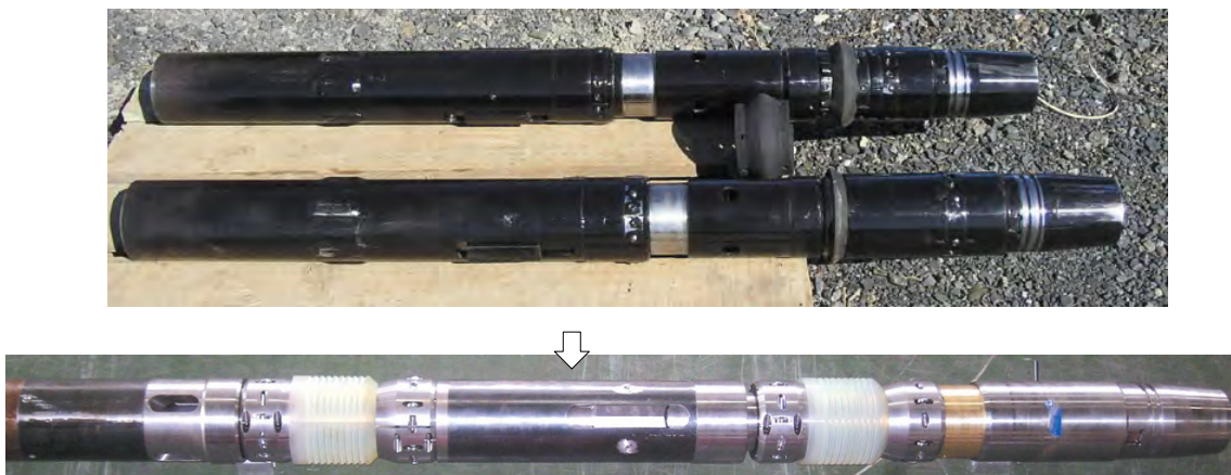
図IV. 2-10 押し込み補助装置（上：当初試作、下：改良（白い部分がテーパ状ラバー））
