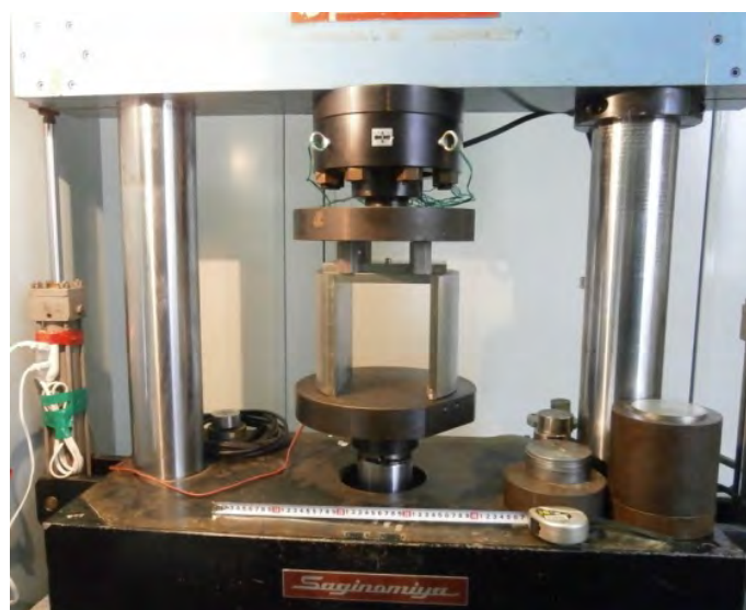
図 6. 2. 1-22 ボルト切断荷重検証試験状況
