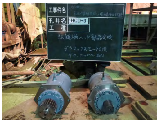
図 8.2.2-15 故障したダウマックスモータの取り外し作業状況
