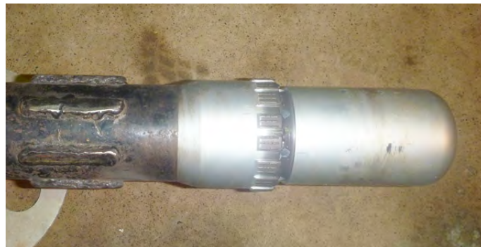
図 8.2.5-3 製作した φ100mm 拡孔ビット
