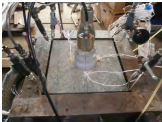
図6.2.1-19 2軸載荷試験装置での型どりパッカの加圧状況
