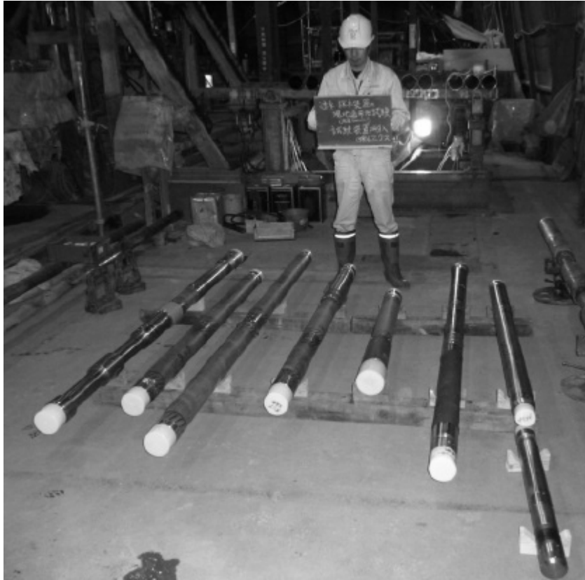
図IV.4-2 透水試験・採水・イメージング装置の全体写真
