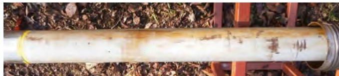
図 6.2.2-15 送り込み試験後の型どりパッカ
