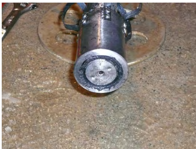
図 8.5.3-10 発破後の装薬治具状況
