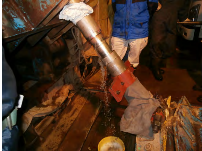
図 8.4.1-10 孔内応力試験装置内への浸水状況
