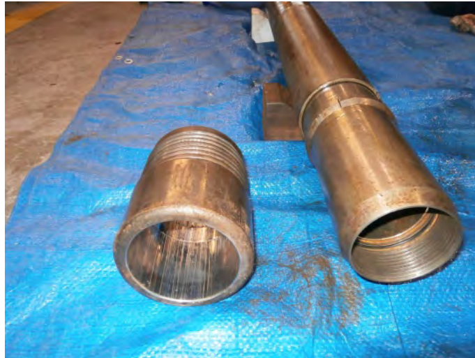
図 6.2.1-28 NL ロッド先端シュー(左)と孔内応力試験装置のラッチシステム(右)
