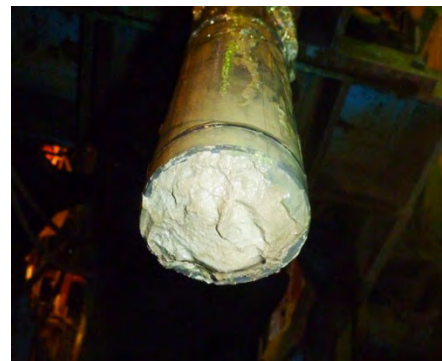
図 8.2.2-10 BQ ロッド管内に残留していたセメントミルク充填材の状況
