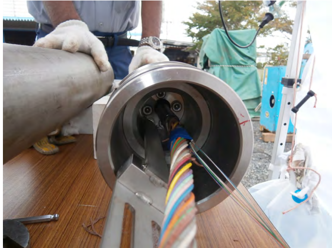
図 6.2.1-3 電源ケーブルと光ファイバーケーブルの分離
