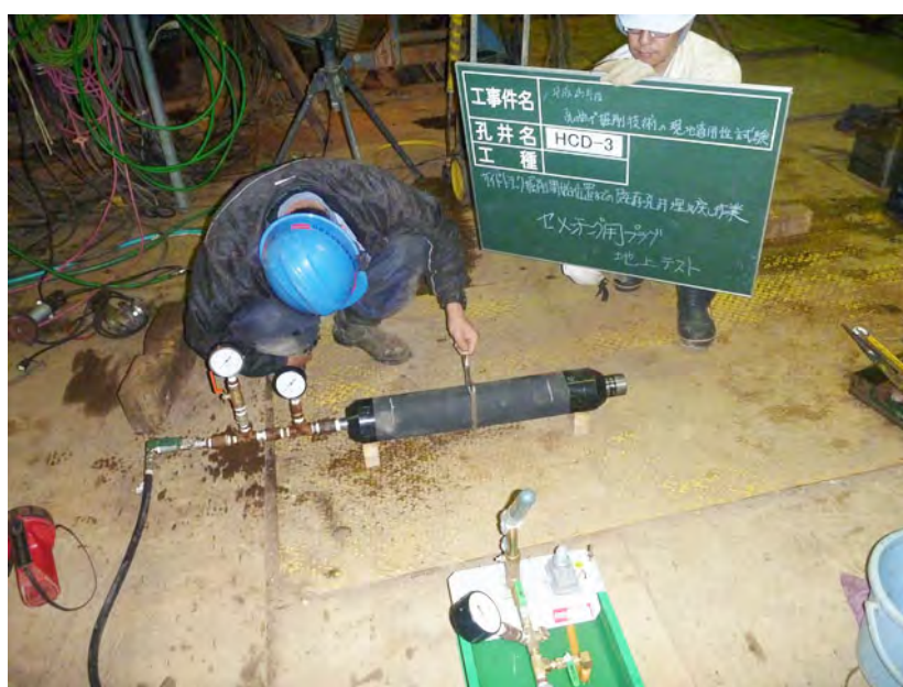
図 5.1.5-5 孔内閉塞用パッカプラグの拡張試験実施状況
