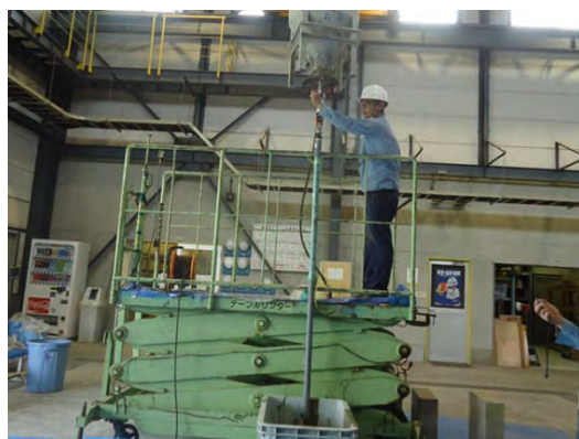
図 5.1.2-7 塩ビ配管を用いた流下状況(垂直のみ)
