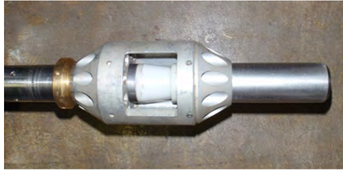
図 8.5.5-3 キャリブレーター (Fluid Velocity Adapter)
