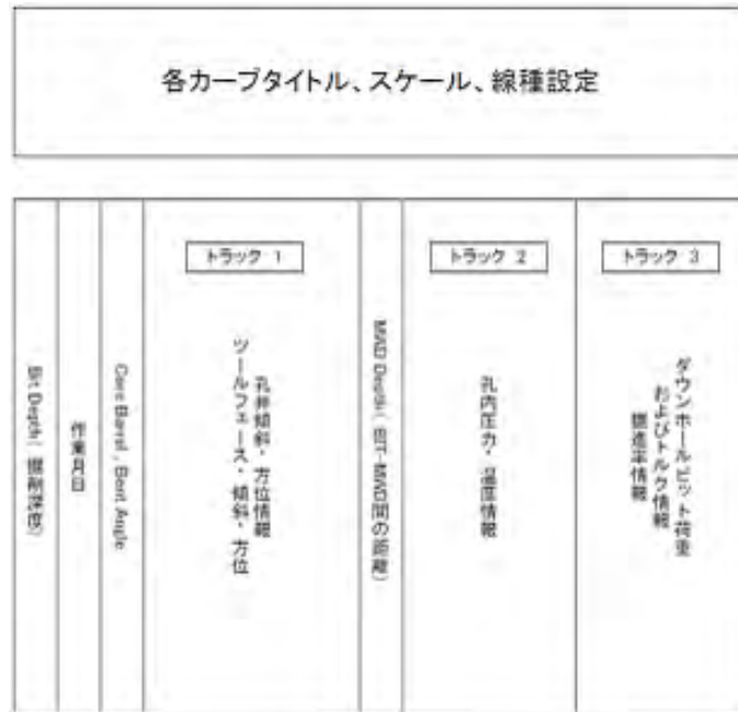
図 8. 2. 4-4 WL-MWD 計測結果出力 Log 形式
