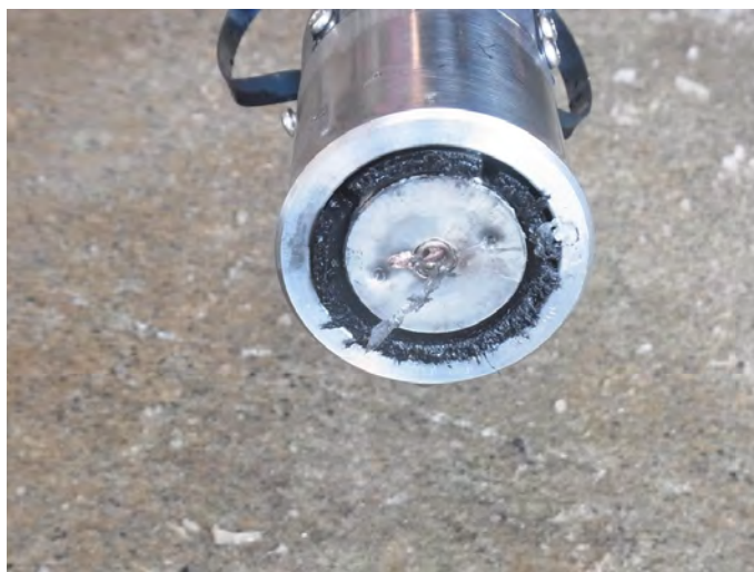
図 8.5.3-14 発破後の装薬治具状況
