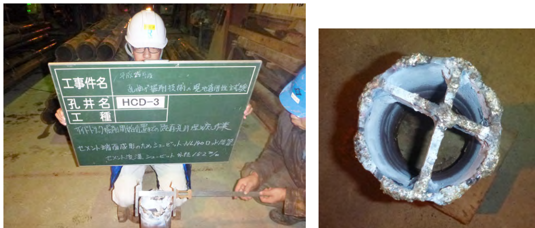
図 8.2.2-12 製作したφ152mm 端面成形用コンポジットシュービット
