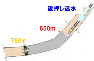
図 5.1.1-3 サイドトラック実施箇所下部のセメンチング概略手順
