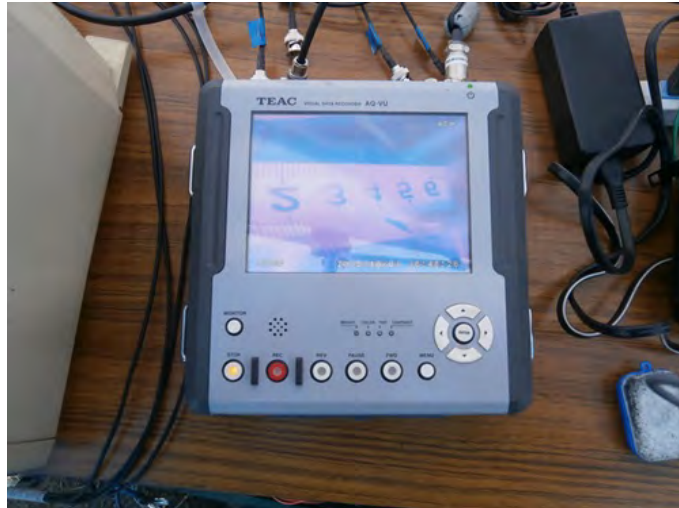
図 6.2.1-16 孔内応力専用ケーブルを介してモニターしたカメラの映像
