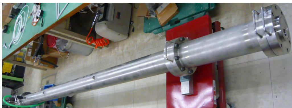
図6.1.1-10 圧力チャンバーを用いたパッカの耐圧試験状況
