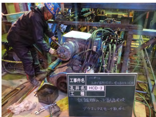
図 8.2.2-15 故障したダウマックスモータの取り外し作業状況
