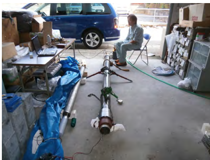
図 6. 2. 1-25 ウィークポイント分離箇所への耐圧性確認試験状況
