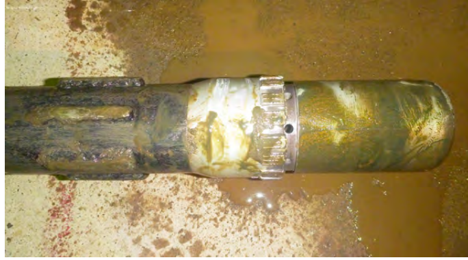
図 8.2.5-5 拡孔後に回収したφ100mm 拡孔ビット
