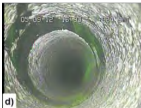
図 6.3.7-1 レジン材充填コア回収後のレジン注入孔（C-FRS 08.002 孔）のボアホールカメラ観察
