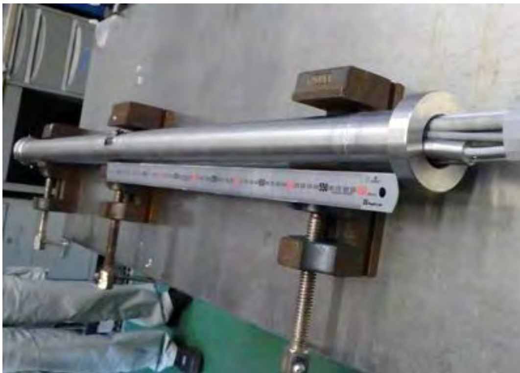
図 2.2.4-5 孔内装置部への循環バルブ組み込み作業 3
