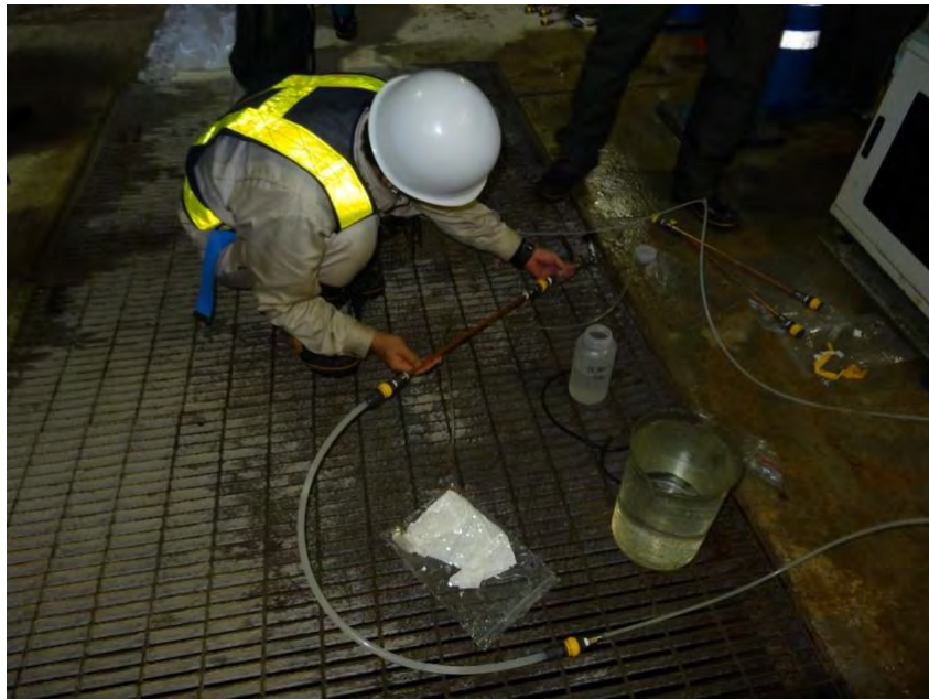
図 9. 4. 1-5 希ガス採取状況
