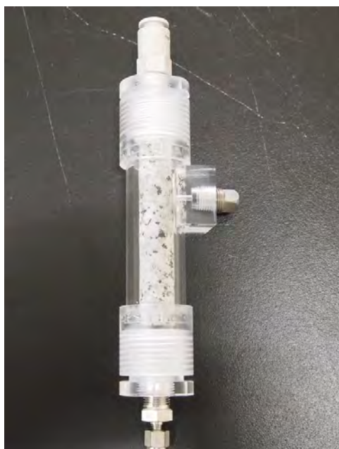
図 8.6.1-1 模擬トレーサー試験に用いた試験用カラム
