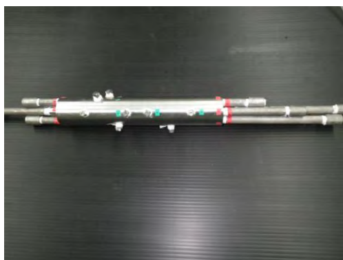
図 2.2.1-6 トレーサー循環バルブの試作器 (実験時)
