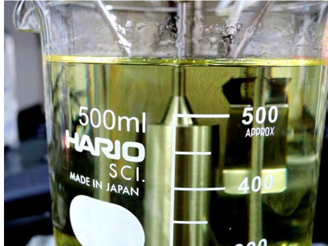
図 6.3.6-3 レジン（混合物）の粘度変化収束時の様子
