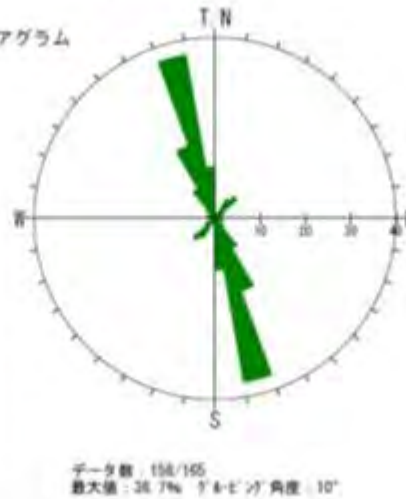
図 7.3.8-5(b) 12MI31 孔ステレオネット図 - 割れ目-
