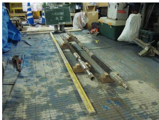
図 7.2.3-34 透水試験設置前の検尺
