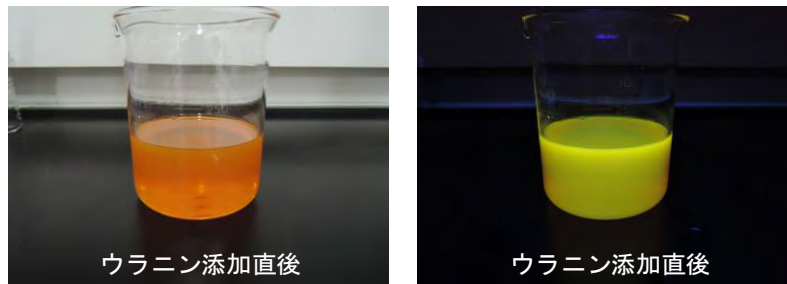
図 6.3.7-4 硬化剤へのウラン添加直後の様子 (左：自然光下、右：紫外線光源下)
