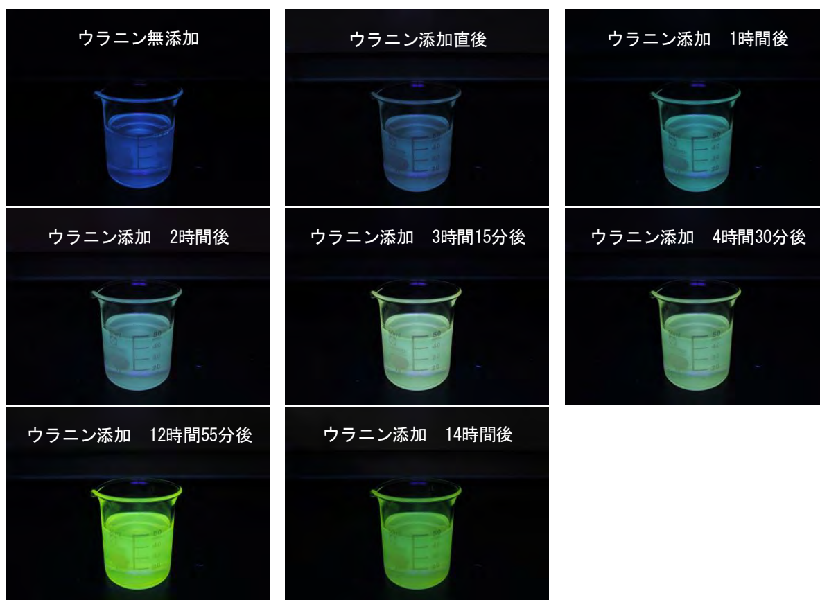
図 6. 3. 7-3 主剤へのウラン添加前後の紫外線光源下での様子
