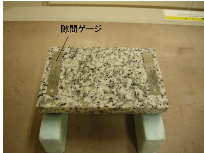
図 6.4.2-2 模擬亀裂花崗岩試料と隙間ゲージ配置状況
