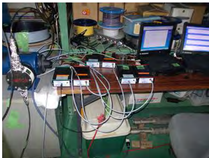
図 2.4.4-16 蛍光センサー測定機器の設置状況
