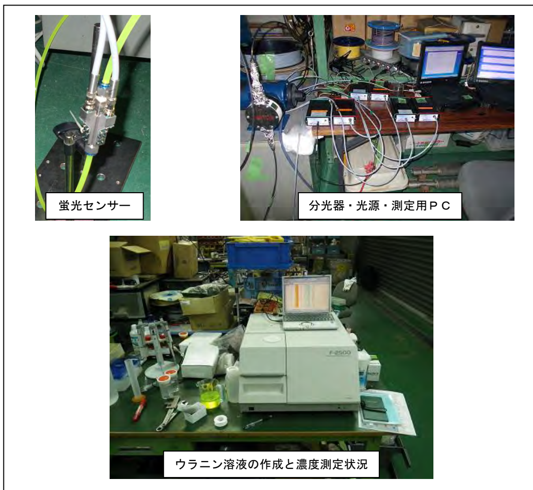
図 2. 4. 3-4 蛍光センサーのキャリブレーション実施状況
