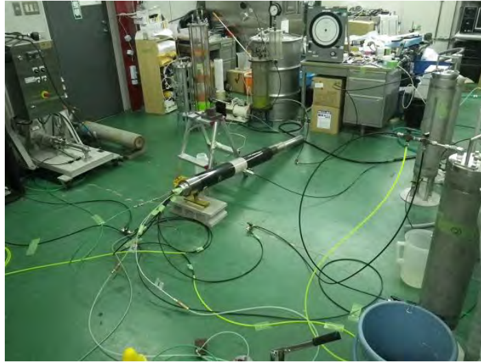
图 2.4.4-11 单孔注水揚水試験状況 1
