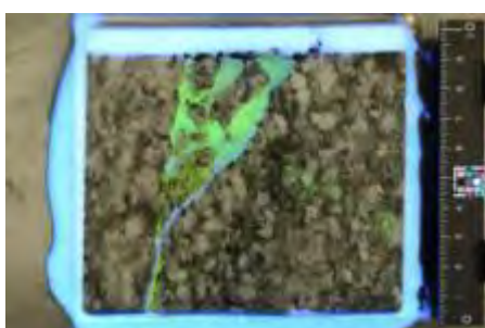
図 6.2.5-25 研削深さ 30mm の研削断面画像と X 線 CT 画像 (C-FRS 12.003 孔)
