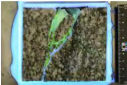
図 6.2.5-27 研削深さ 40mm の研削断面画像と X 線 CT 画像 (C-FRS 12.003 孔)
