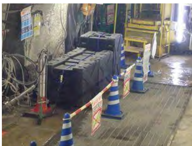
図 7.3.9-2 設置後の間隙水圧モニタリング装置地上部
