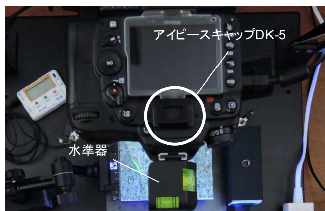
図 6.2.2-4 ファインダーからの光の進入防止とカメラの水平の確保
