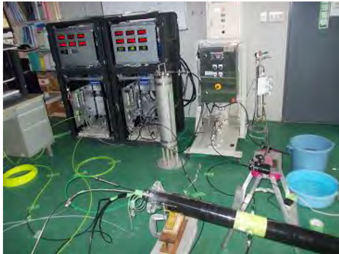
図 2.4.4-3 ポイント希釈試験状況 1
