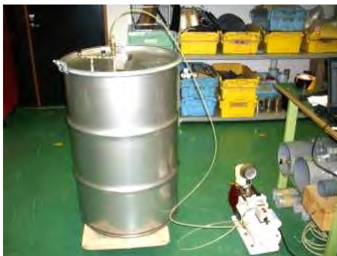
図 2.4.2-7 試験に使用した脱気水作成状況
