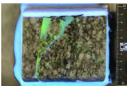
図 6.2.5-23 研削深さ 20mm の研削断面画像と X 線 CT 画像 (C-FRS 12.003 孔)
