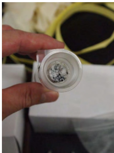
図 8.6.1-1 模擬トレーサー試験に用いた試験用カラム
