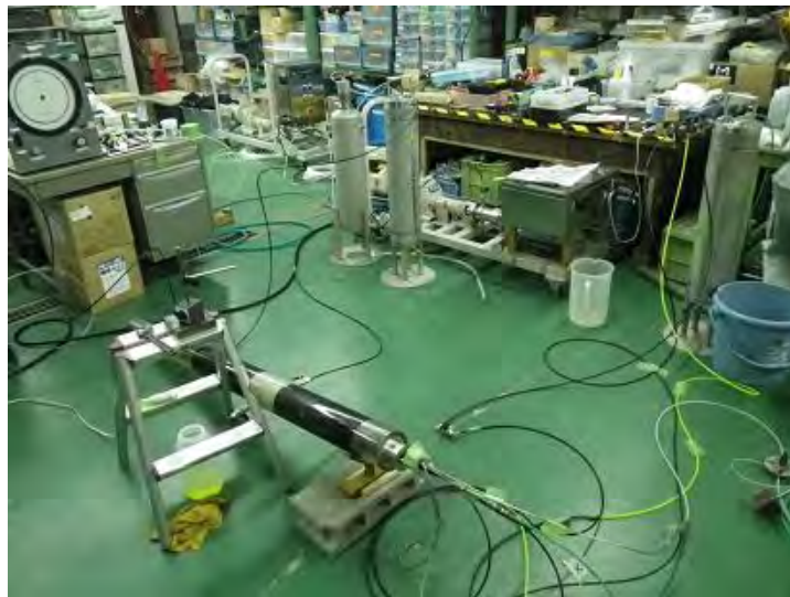
图 2.4.4-13 单孔注水揚水試験状況 3
