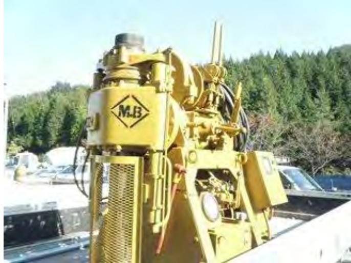
図 7.2.3-1 ボーリングマシン
