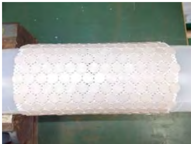
図 2.4.2-6 試験区間形成に使用したポリエステルメッシュおよび PEEK スペーサ
