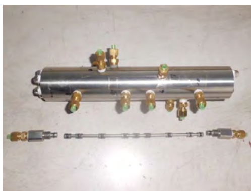
図 2.2.1-5 トレーサー循環バルブの試作器 (溶解研磨加工時)
