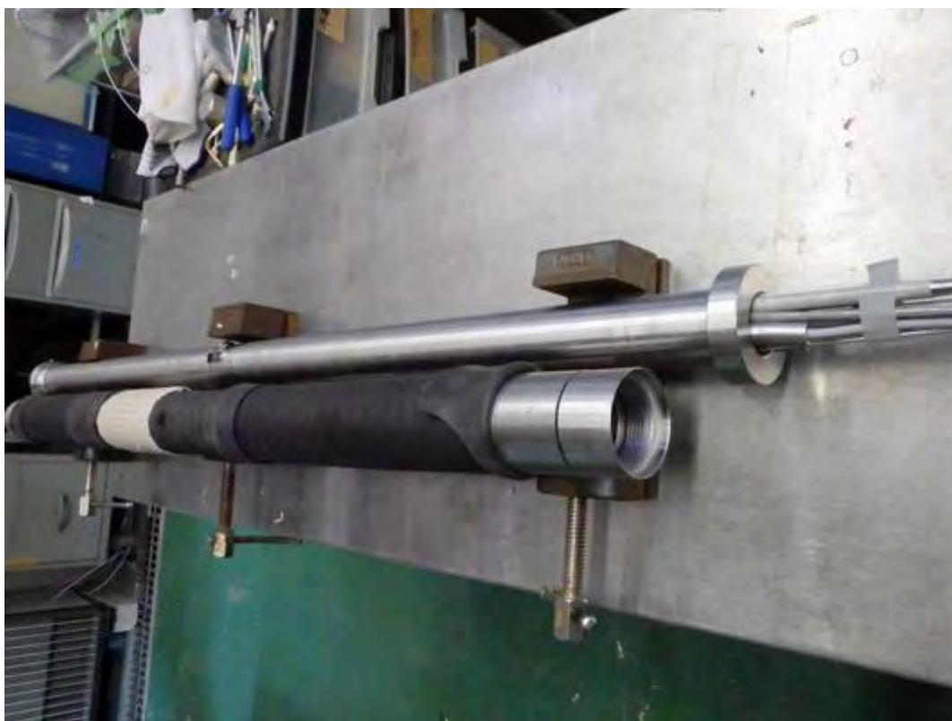
図 2.2.4-6 孔内装置部への循環バルブ組み込み作業 4
