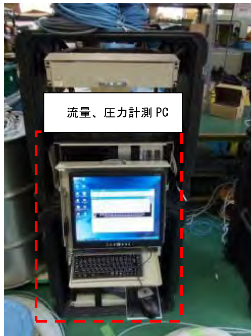
図 2.4.2-5 性能確認試験に使用した機材④
