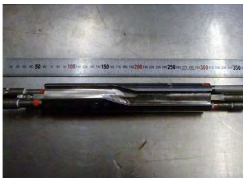
図 2.2.4-1 循環バルブの S 字型溝加工
