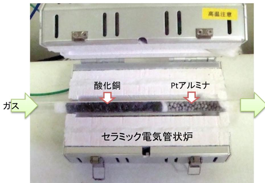
図 3.2-9 管状炉と石英管の触媒
