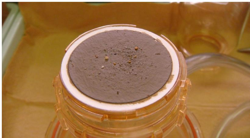
図 3.2-3 GF/F ガラスフィルター上に捕集した土壌試料
