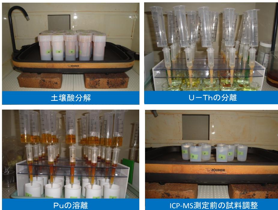
図 4.2-7. 土壌中 Pu 定量のための主な分析操作の様子
