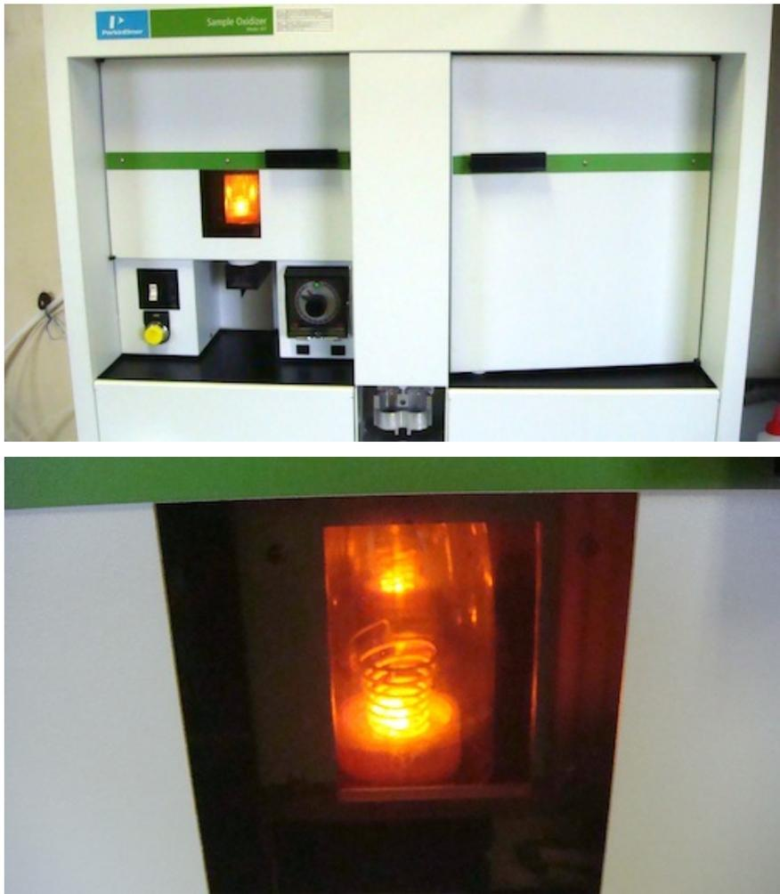
図 3.2-7 サンプルオキシダイザ（上）とオキシダイザによる土壌の燃焼（下）
