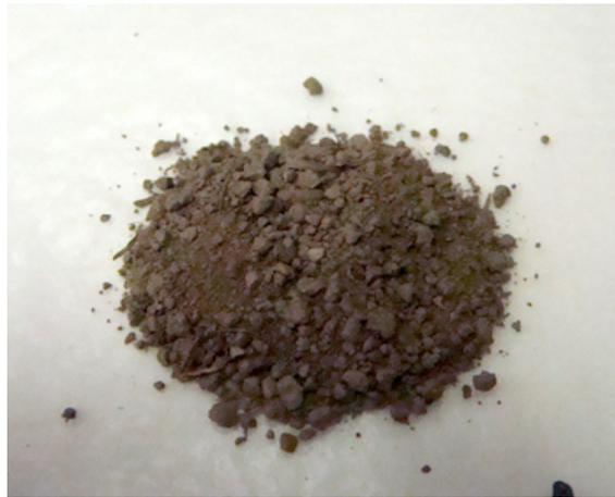
図 3.2-1 乾燥後ふるいにかけて礫を除いた土壌試料
