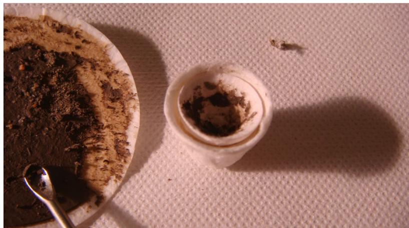
図 3.2-6 コンバストコーン上に採取した土壤試料
