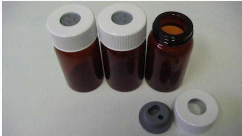
図 3.2-2 湛水土壌試料の褐色ガラスバイアル瓶
