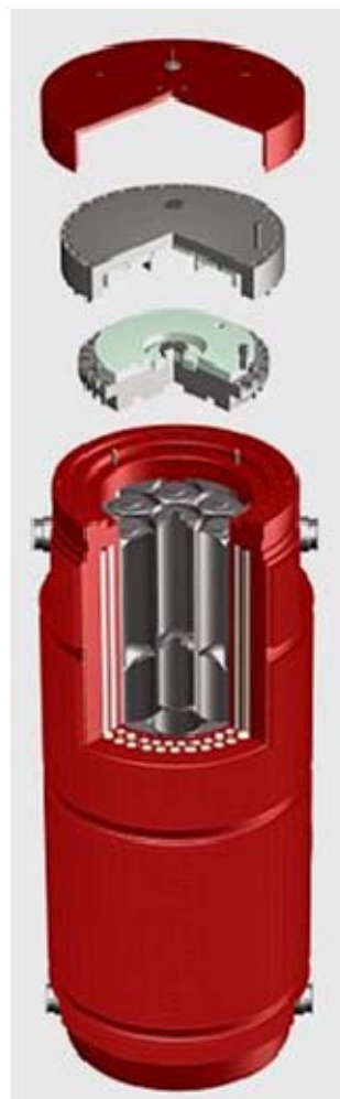
図 8.3-1 CASTOR ® HAW28M(GNS)の主要設計
