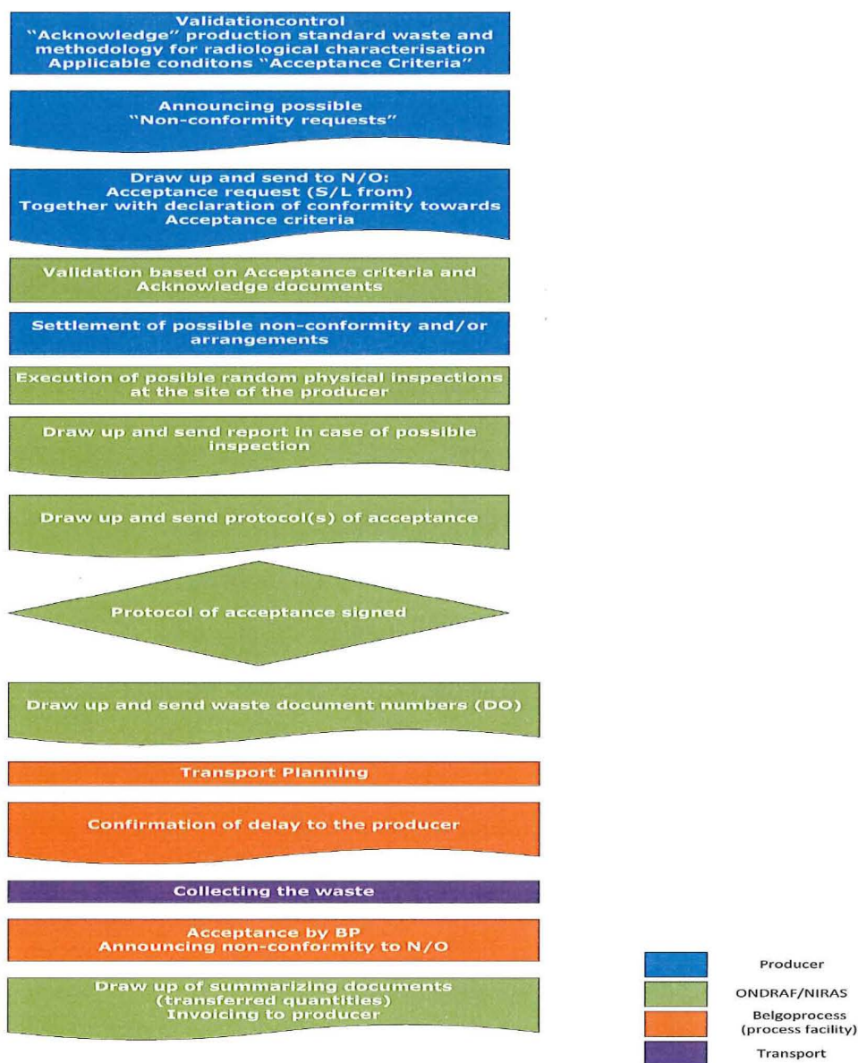
図 10.3-1 放射性廃棄物管理での受入れ手続き、撤去及び所有権の移転の詳細ワークフロー
