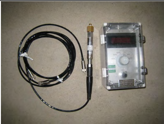
写真 1.4-17 間隙水圧計、表示器
