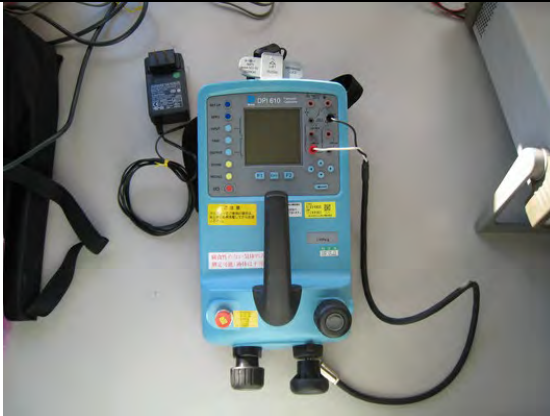
写真 1.4-22 点検機器 (圧力校正器)
