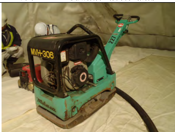
写真 1.3-20 使用機材（バイブロコンパクター）
