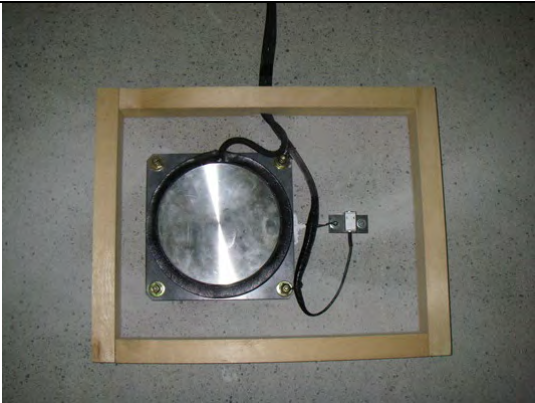
写真 1.4-1 計測計器設置 (土圧計、加速度計)
