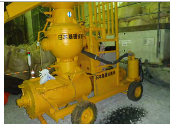
写真 1.3-19 使用機材（吹付け機）
