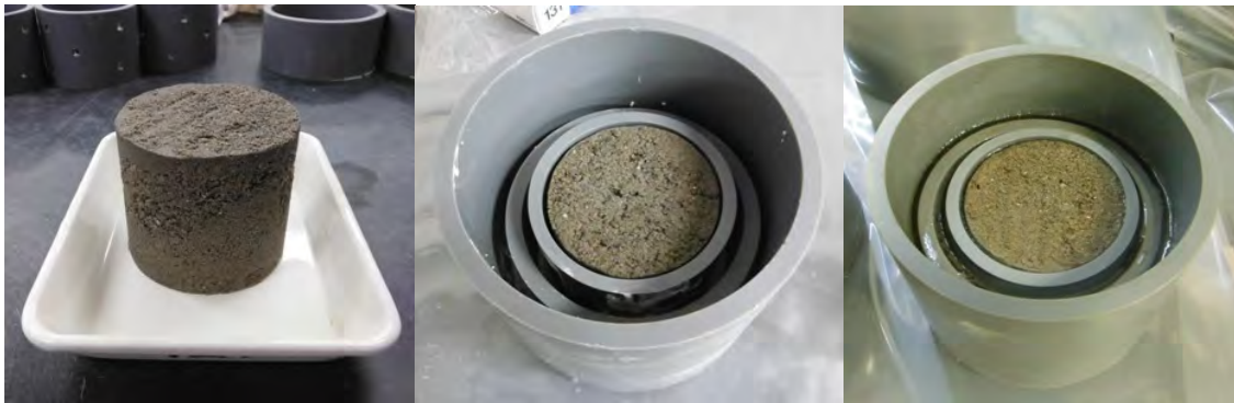
図 5.2-15 供試体と透水円筒との隙間の充填状況
