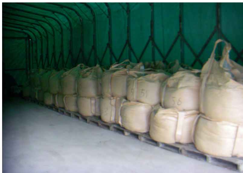
図 3.1-26 ベントナイト保管状況
