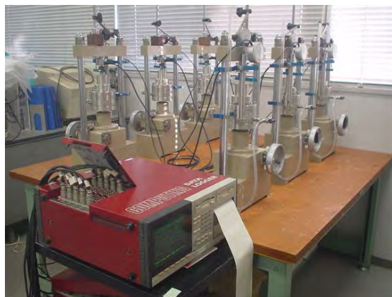
図 3.2-30 膨潤圧試験装置
