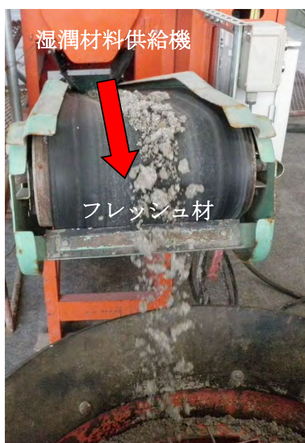
図 2.1-20 フレッシュ材とリバウンド材の供給状況
