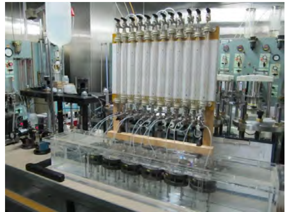
図 2.2-11 シリコンオイル比重法に用いた計測器
