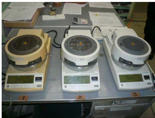
図 3.1-25 調整後含水比測定状況
