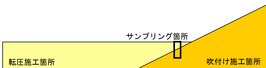
図 3.1-73 施工境界部における試料サンプリング
