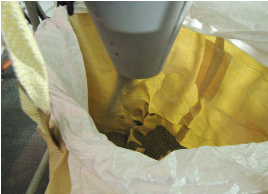
図 3.1-77 サイクロンから材料が排出されている様子
