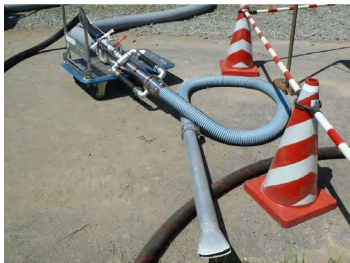
図 2.1-8 吸引式リバウンド材回収装置
