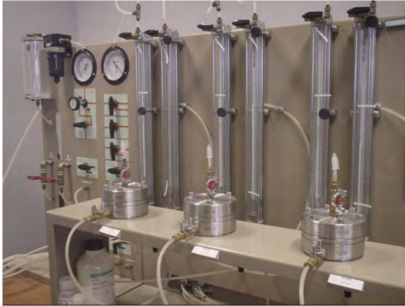
図 3.2-23 透水試験装置
