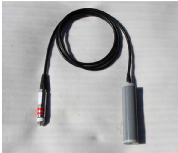
図 9.4-2 間隙水圧計付き小型地中無線送信機
