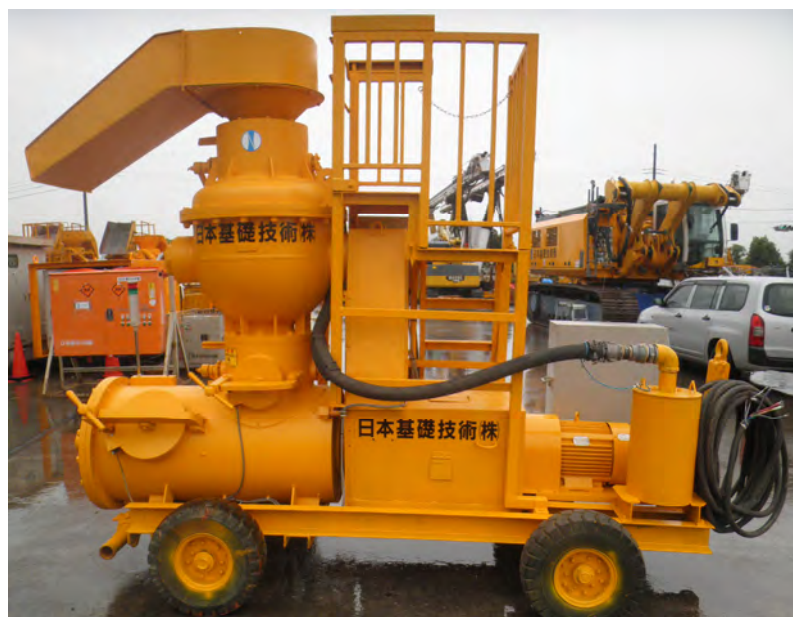
図 5.1-12 圧力釜式吹付け機
