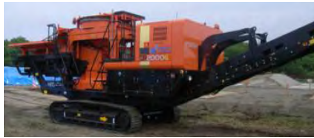
自走式土質改良機 SR-2000G (連続式機械)
