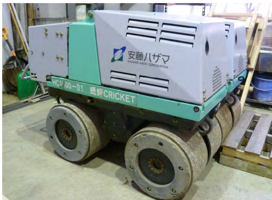
図 3.1-20 小型振動ローラ（HC1500-1）
