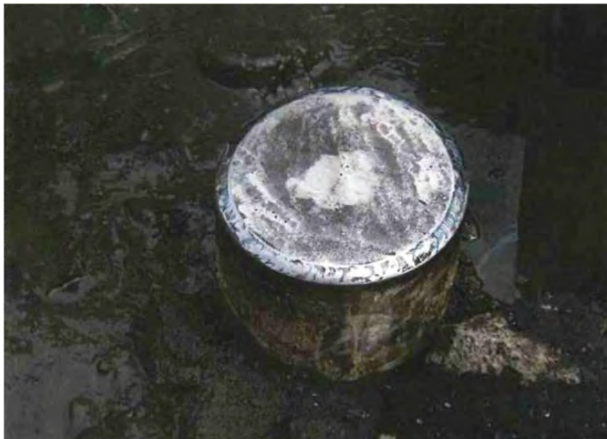
図 9.2-17 ケーシング頭頂部の溶接による閉塞[12]
