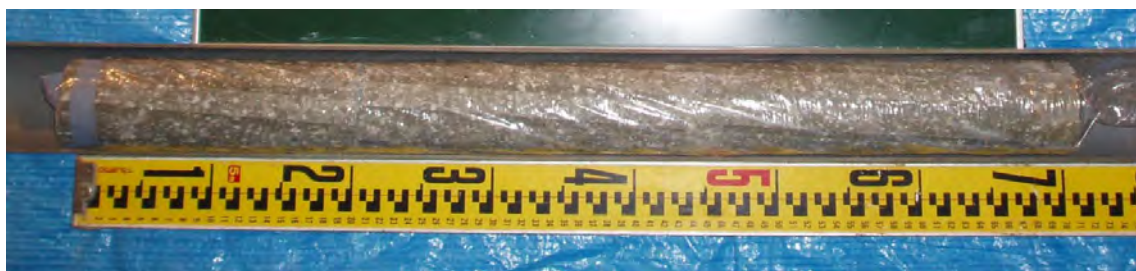
図 2.2-3 長尺ボーリングマシンにより採取したコアの一例
