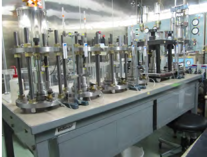
図 2.2-12 膨潤圧試験状況
