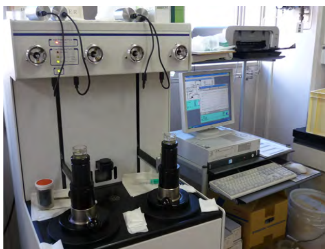
図 7.2-8 水銀圧入試験装置
