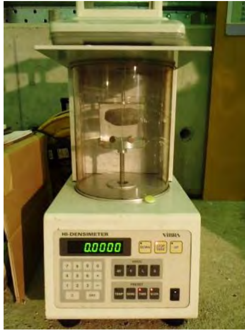
図 2.1-25 シリコンオイル法に用いた計測器
