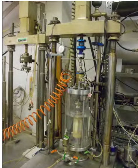
図 6.3-1 三軸圧縮試験装置
