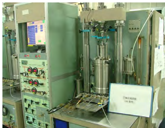
図 2.2-7 三軸圧縮試験状況
