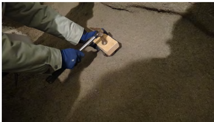
図 5.2-9 シンウォールサンプラーを施工層に貫入している状況
