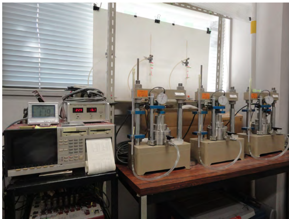
図 5.2-4 膨潤圧試験装置
