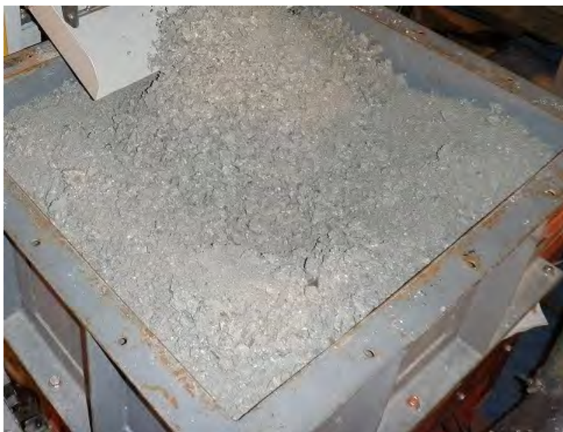
図 2.1-19 ホッパーに材料投入した状態の湿潤材料供給機の状況
