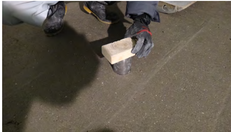
図 5.1-54 シンウォールサンプラーによるサンプリング状況
