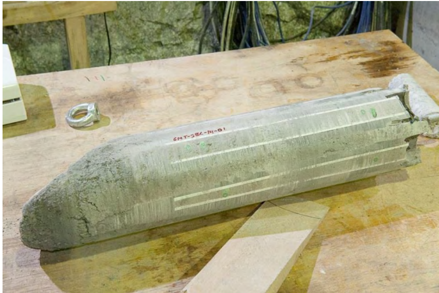
図 2.1.4-28 取り出した直後の Box-core-2 コア試料
