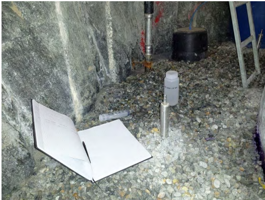
図 2.1.4-34 ベントナイト混合土を覆う砕石層から間隙水を揚水している状況
