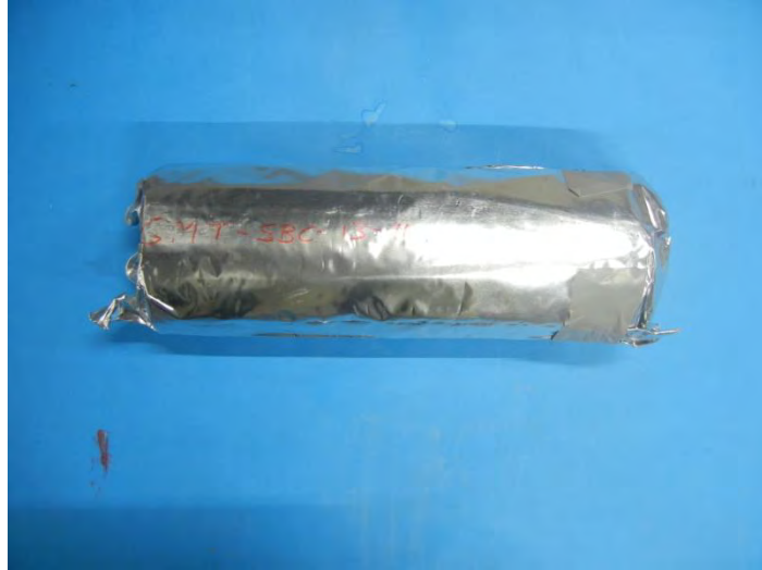
図 2.1.4-36 Box-core-1 のアルミ入り樹脂製パックを取り除く前の状態
