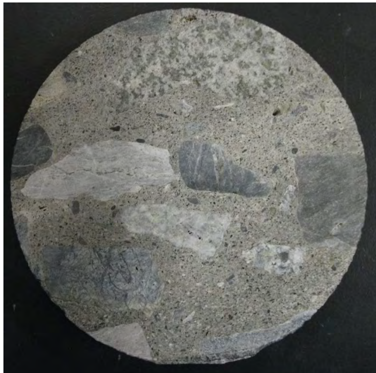
図 3.1.3-2 1960 年製造（昭和 35 年）の熱影響を受けたコンクリート試料
