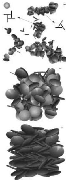
図 2.3.2-1 シミュレーションで再現したスメクタイトゲル無秩序積層構造体 (Dijkstra et al., 1997)[18]
