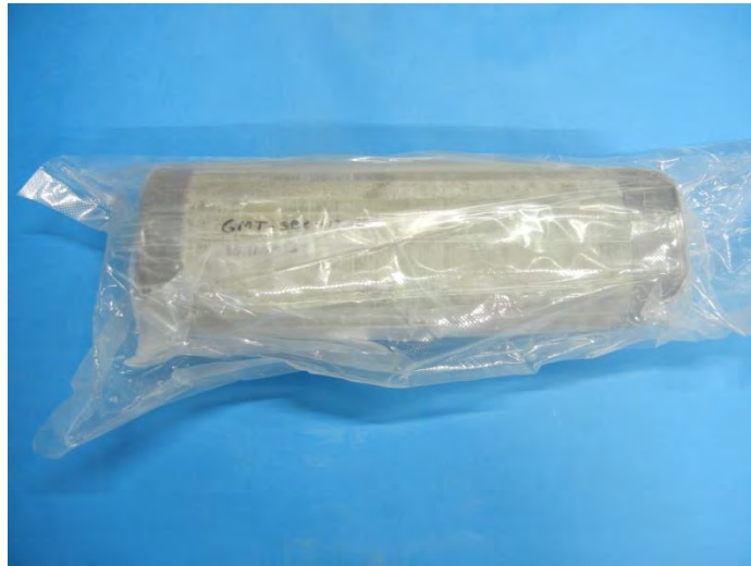
図 2.1.4-37 Box-core-1 のアルミ入り樹脂製パックを取り除いた後の状態
