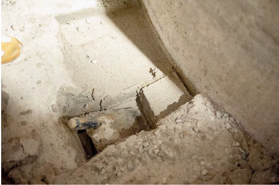
図 2.1.4-5 Silo-block-1 試料の採取状況
