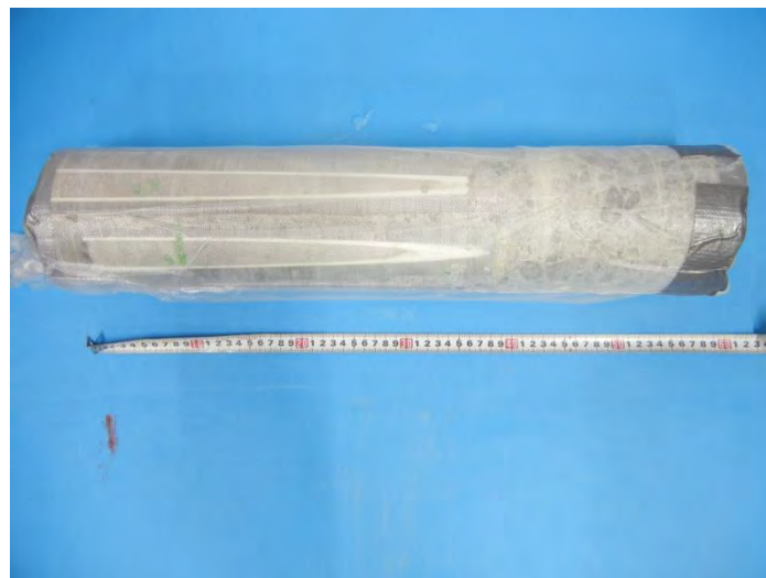
図 2.1.4-41 Box-core-3 のアルミ入り樹脂製パックを取り除いた後の状態
