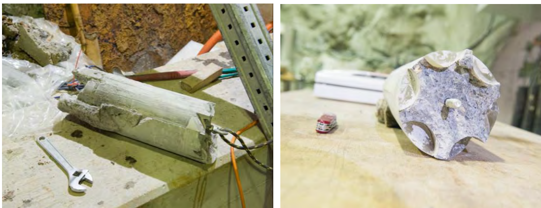
図 2.1.4-18 オーバーコアリングした試料の周辺部のベントナイト混合土を除去している状況
