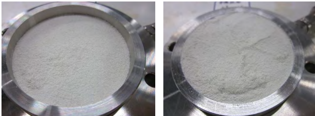
図 2.1.2-2 クニピア F 充填後の様子 (左が 0.2Mg/m 3 、右が 0.5Mg/m 3 )
