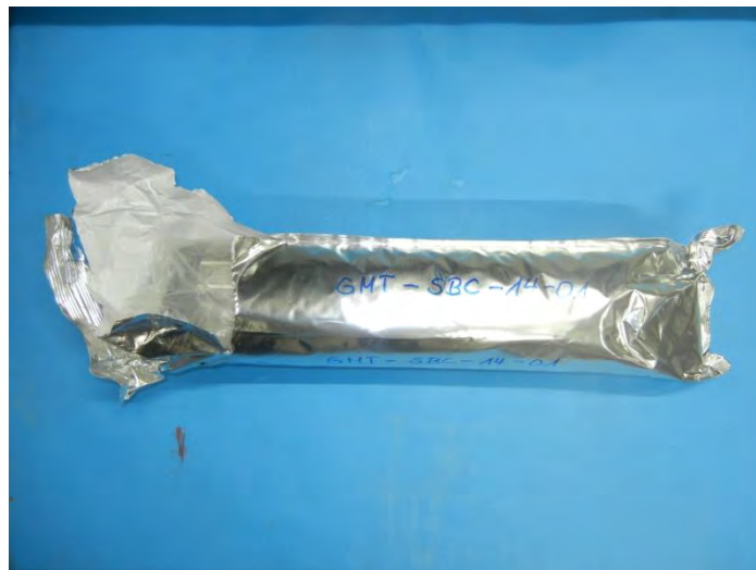
図 2.1.4-38 Box-core-2 のアルミ入り樹脂製パックを取り除いているところ
