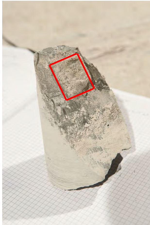
図 2.1.4-12 採取したコア試料（赤線で囲んだ箇所にベントナイト混合土が固定されている）
