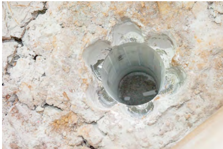
図 2.1.4-31 Box-core-3 コアを取り出した後の孔内の状況
