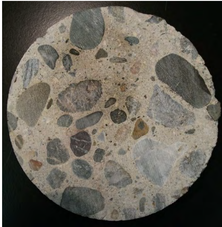
図 3.1.3-3 1959年製造（昭和34年）の熱影響を受けたコンクリート試料
