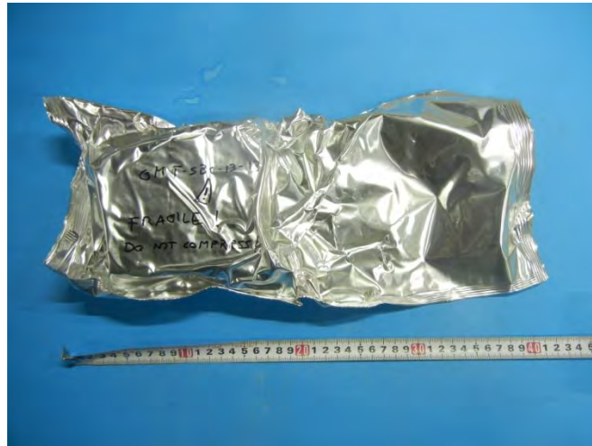
図 2.1.4-42 Silo-block-1 のアルミ入り樹脂製パックを取り除く前の状態
