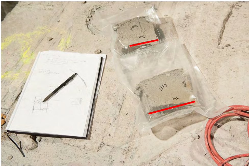
図 2.1.4-6 サンプル袋に入れて真空養生している Silo-Block-1 の状況 (赤線の面がサイロコンクリートとの接触面)
