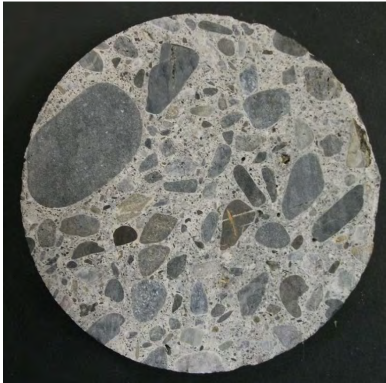
図 3.1.3-1 1933 年製造（昭和 8 年）の熱影響を受けたコンクリート試料
