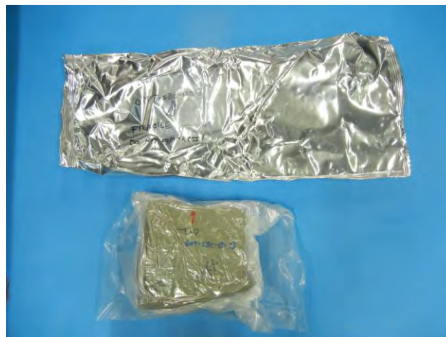
図 2.1.4-43 Silo-block-1 のアルミ入り樹脂製パックを取り除いた後の状態
