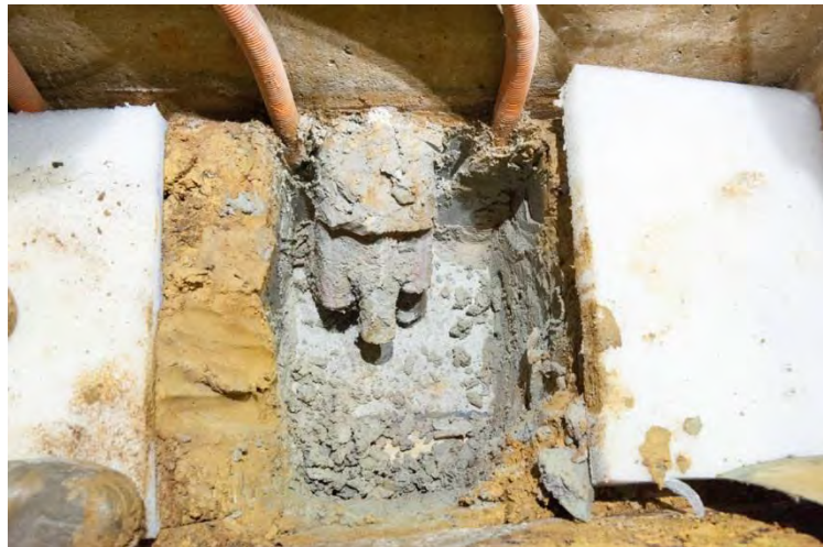
図 2.1.4-18 オーバーコアリングした試料の周辺部のベントナイト混合土を除去している状況
