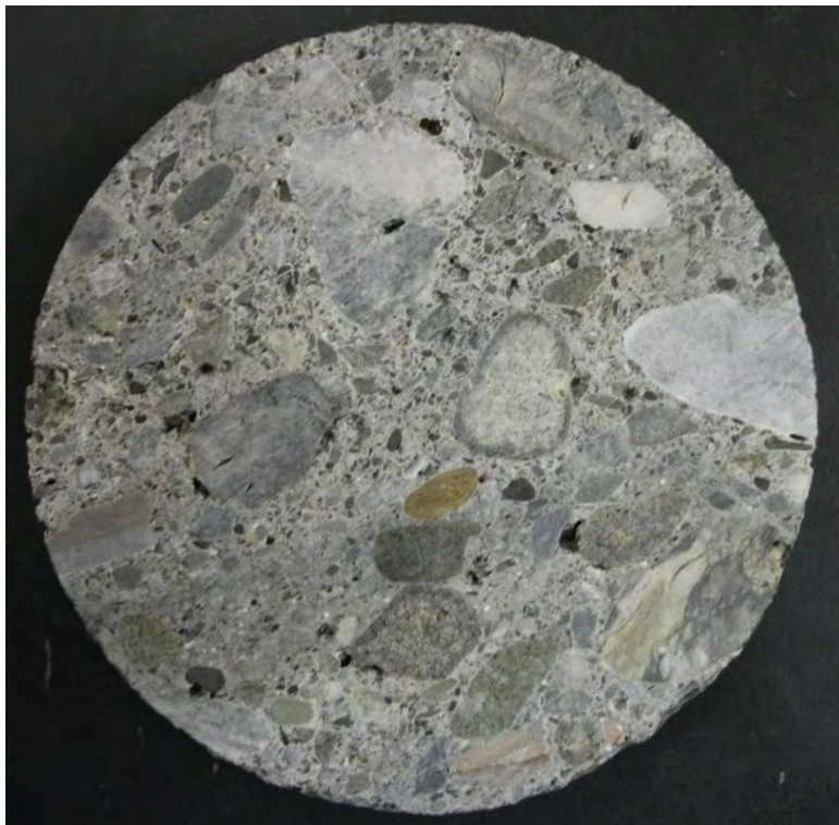
図 3.1.3-4 1933年製造（昭和8年）の熱影響を受けていないコンクリート試料
