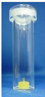
図 3.5.1-19 X線 CT 撮像に用いた容器の外観
