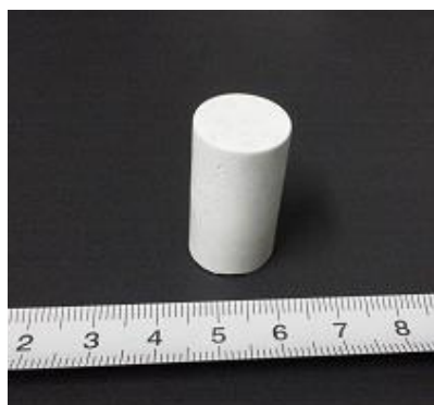
図 4.4.3-3 比熱測定に用いたセメント固化体試料の外観
