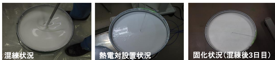
図 4.4.4-4 20L スケール固化試験状況 (Run1)
