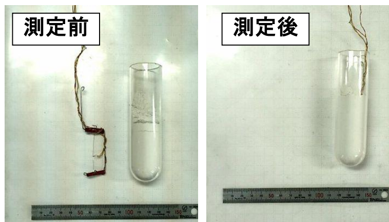
図 4.4.3-2 熱伝導率測定前後のセメント固化体試料の外観
