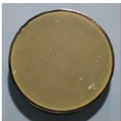
図 2.2.2-1 岩石固化体断面
