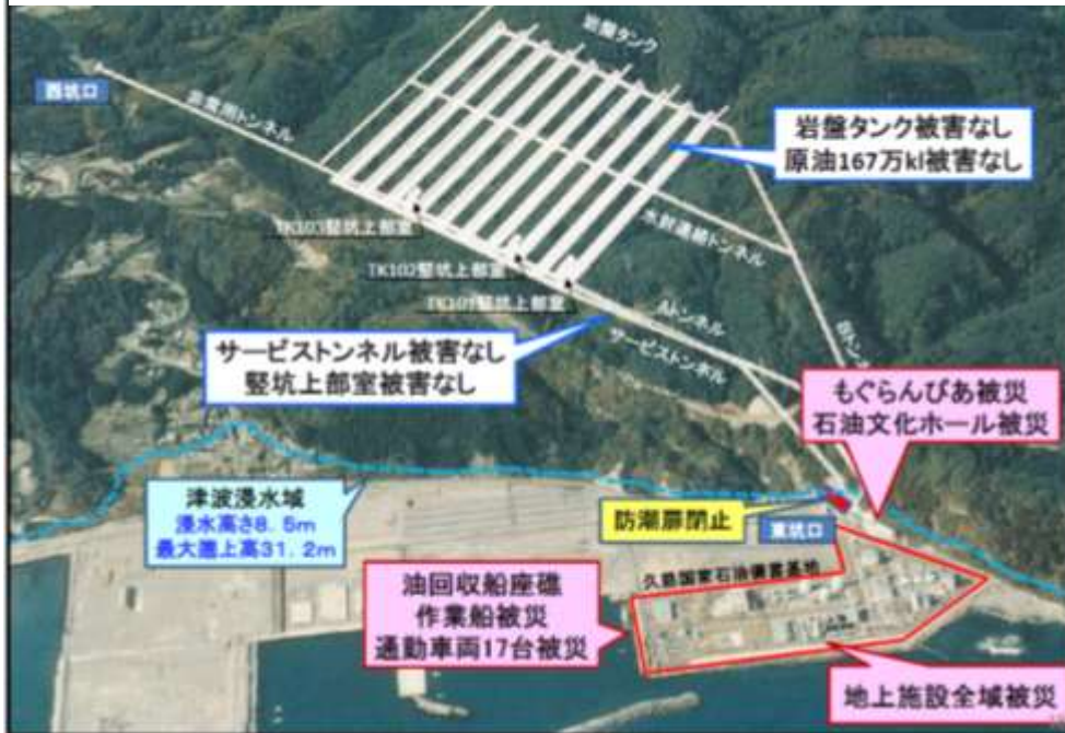
岩手県久慈国家石油備蓄基地における東日本大震災での被災状況
