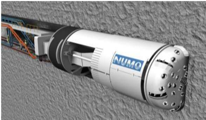
掘削工法の一つである トンネルボーリングマシン
